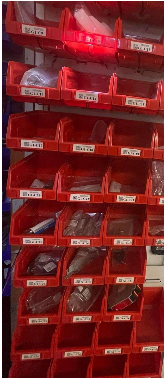
Figura 16.- Encendido del LED en la gaveta.
