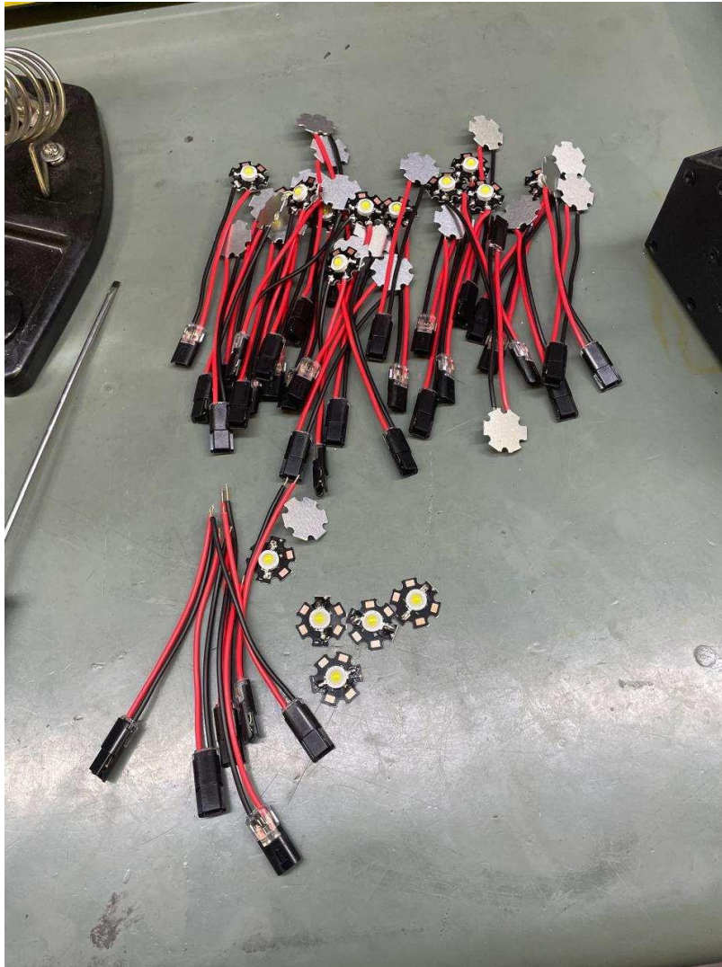
Figura 8.- Colocación de conectores rápidos.
