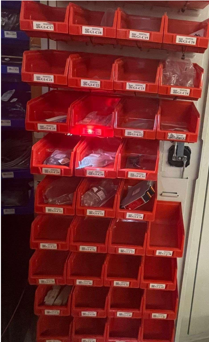
Figura 18.- Encendido del LED en la gaveta.
