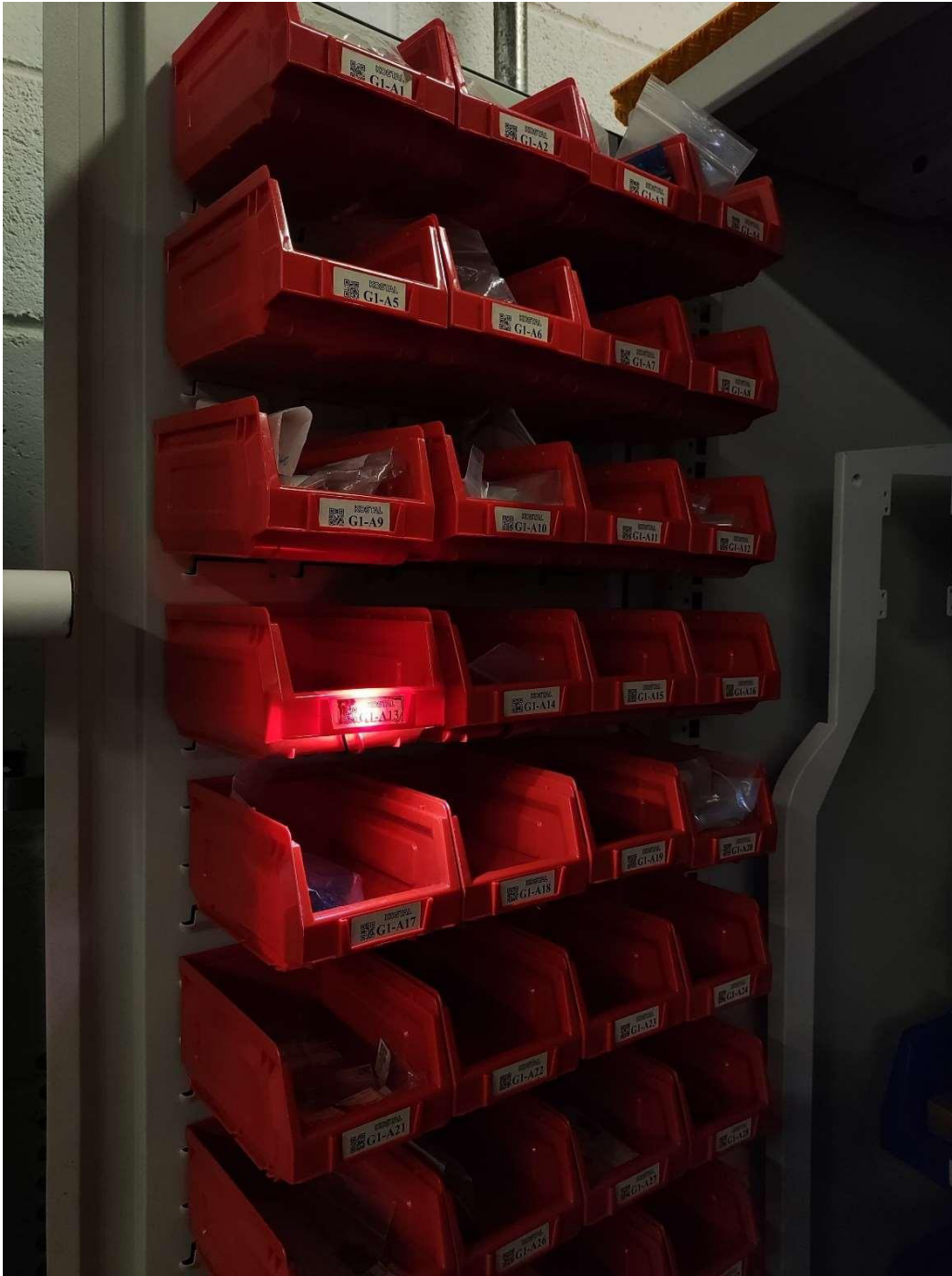
Figura 13.- Encendido del LED en la gaveta.
