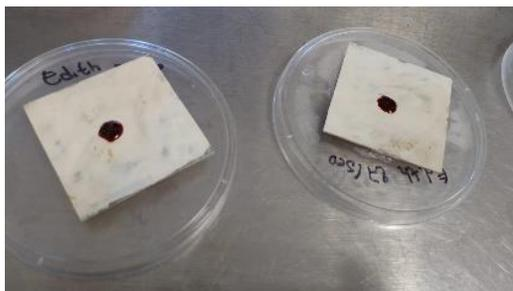
**Figura 3.11** Preparación para el montaje de la celda. Placas con la mezcla de óxido de titanio, tinte de mora y una pequeña cantidad de mertiolate, el cual sirve para activar la placa
