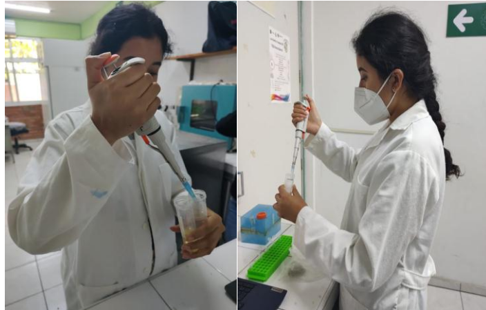
Figura 8. Se le agregó 30 ml de agua estéril en un tubo y se le agregó 7 ml de tween 80 y se agitó durante 10 min.
