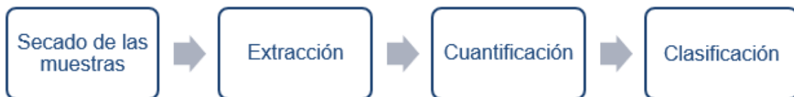
Figura 11. Caracterización de microplásticos propuesto por Álvarez-Zeferino et al. (2020) (trabajo de laboratorio).
