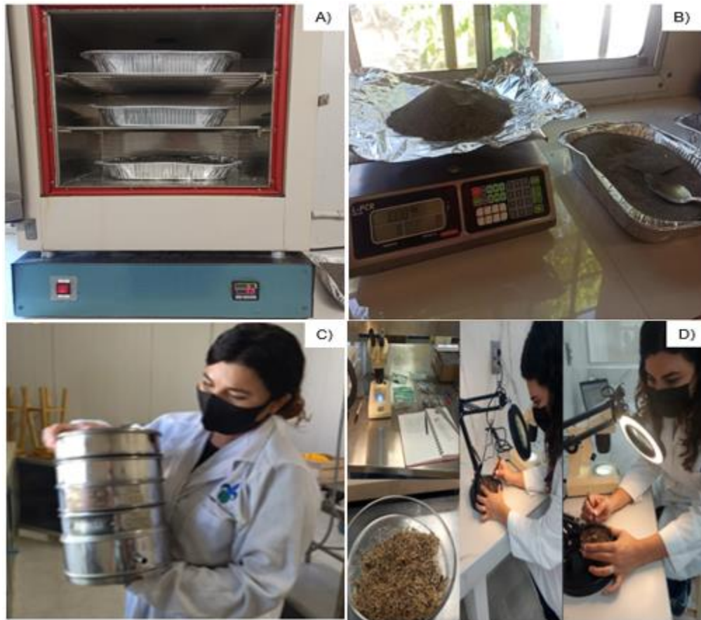
Figura 12. Procesamiento de las muestras en Laboratorio LIRA: A) secado, B) pesado, C) tamizado y D) extracción y cuantificación de microplásticos.
