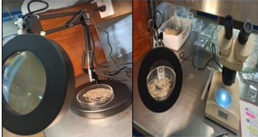
Figura 13. Clasificación visual de microplásticos en laboratorio LIRA.
