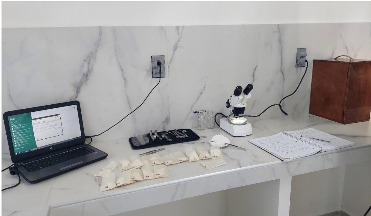
**Figura 7.** Análisis de microplásticos en microscopio estereoscópico por forma, color y tamaño.
