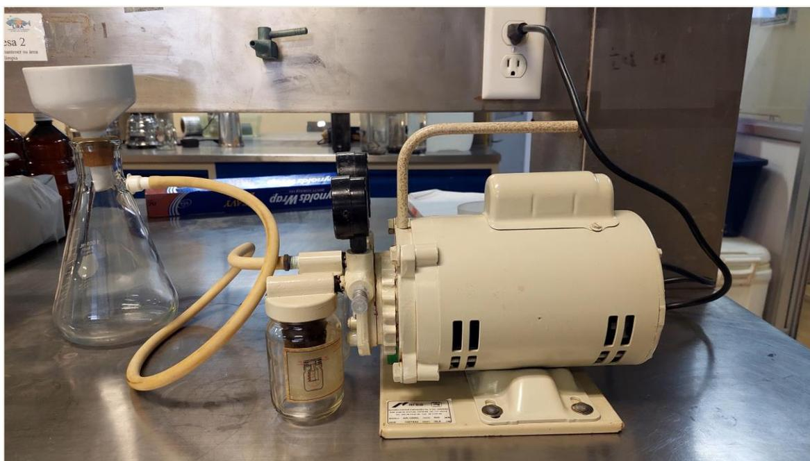
**Figura 5.** Filtrado de la degradación de intestinos y branquias con bomba de vacío.
