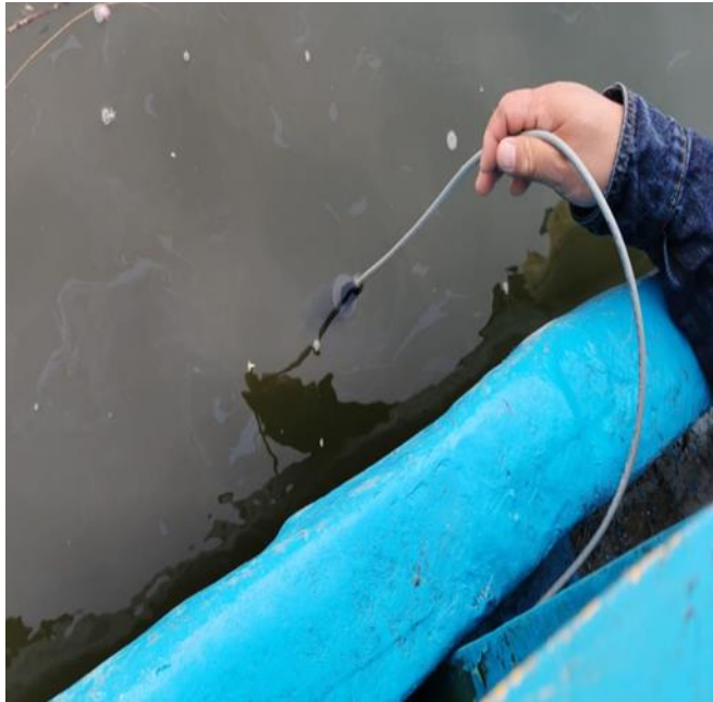
Figura 2. Toma de parámetros físico-químicos in situ con sonda del multiparámetro Hanna HI9828 en el estuario Arroyo Moreno, Boca del Río, Veracruz.
