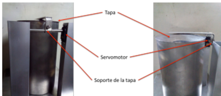
Figura 8. Sistema mecánico de captación. Fuente García (2020).
