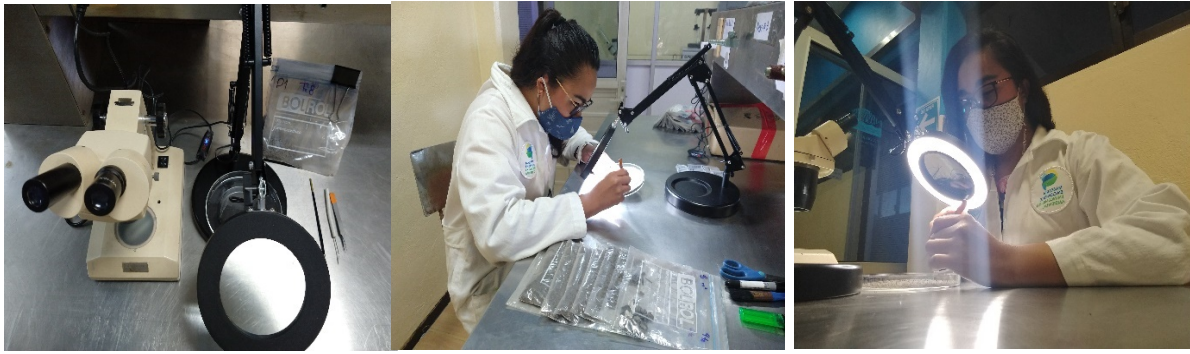
Figura 36. Proceso de identificación de microplásticos por color, tipo y tamaño en sedimentos tamizados. Fotografías propias.
