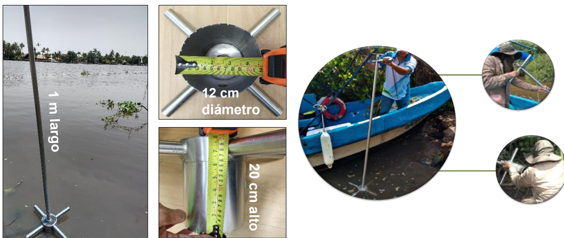
Figura 33. Nucleador y proceso de recolección de muestras de sedimento. Fotografías propias.
