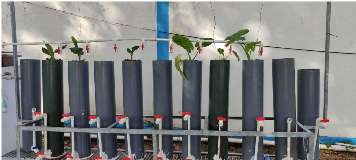
Figura 46 Sistema humedal artificial prototipo montado inicial
