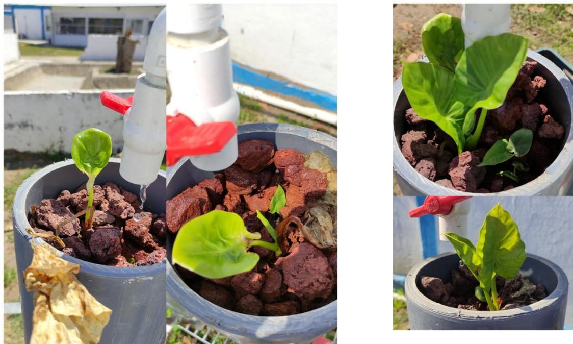
Figura 48 Prototipo humedal artificial con *Xanthosoma robustum*, pequeños brotes, adaptación al sistema positivo
