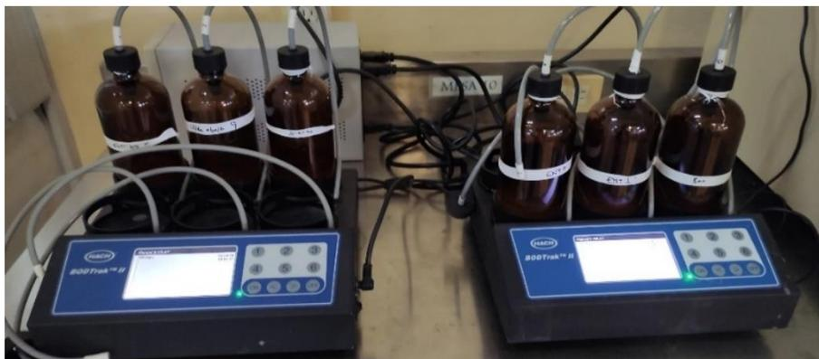
Figura 17 BODTrack II "Medidor de DBO5"
