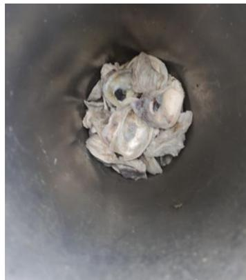
*Figura 12 Configuración de sistema interior 30 cm de concha de ostion*
