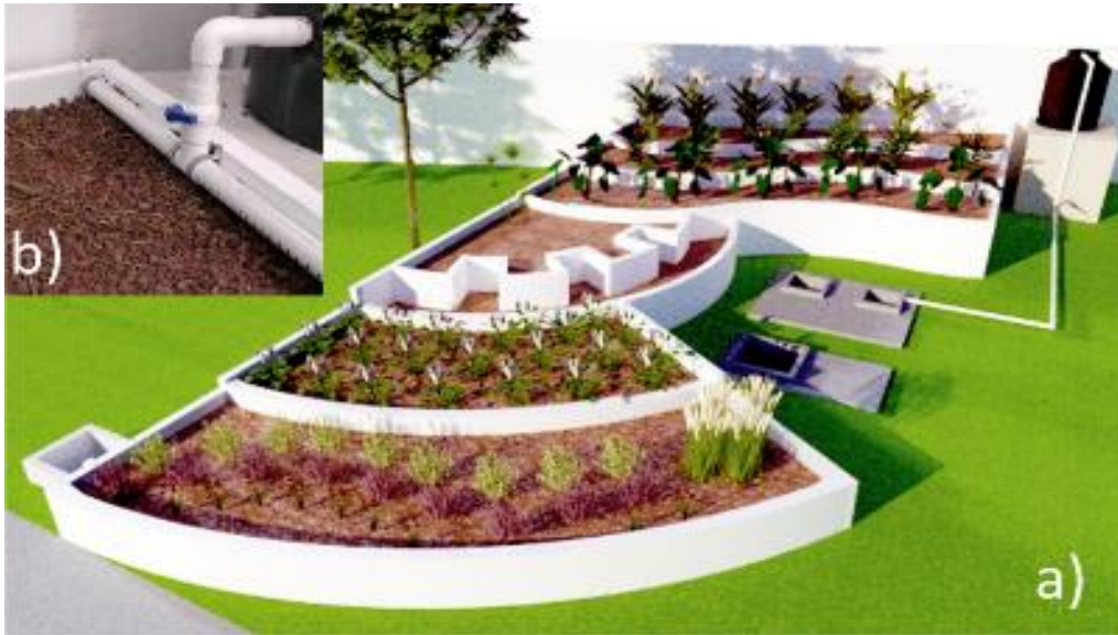
Figura 14 .Sistema HAHFSS; a) Render suministro de agua, b) Tubo de alimentación a la primera celda. Fuente: Amaya., 2019
