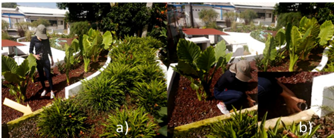
Figura 26. Recolección muestra para los análisis de la calidad del agua residual. a) Salida del agua residual de cada celda para permitir los muestreos, b) Toma de muestra. Fuente: Lara., 2020.
