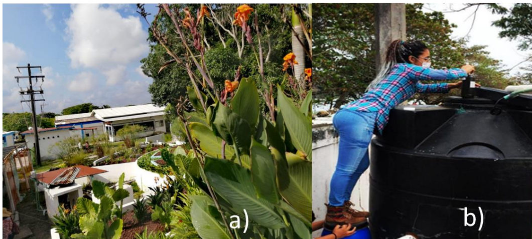
Figura 25. Aclimatación del HAHFSS a las nuevas condiciones de agua residual. a) HAFSSH después del crecimiento de la vegetación, b) Toma de muestra del influente, entrada en el tanque de alimentación. Fuente: Lara., 2019
