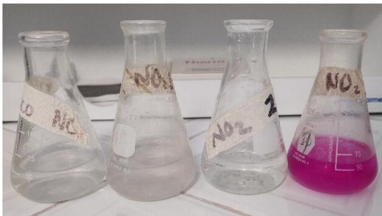
Figura 7.13. Análisis de nitritos en muestra de agua de salida de filtro de carbón activado
