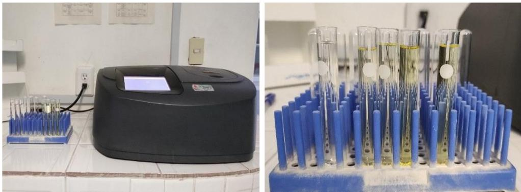
Figura 6.30. Lectura de absorbancia de muestras para nitrógeno de nitratos
