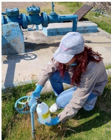
Figura 6.15. Muestreo de agua de salida de planta potabilizadora "El Bordo"
