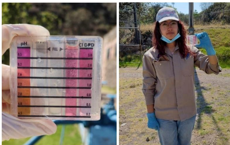
Figura 6.18. Determinación de cloro libre residual por comparación colorimétrica
