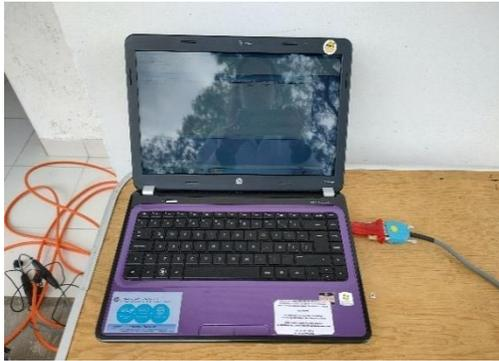
Conectar el equipo con el cable de medición al puerto USB de la computadora, asegurándose de que la batería interna recargable esté cargada.
