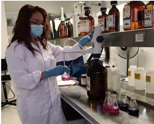
Figura 6.22. Determinación de dureza total y dureza de calcio
