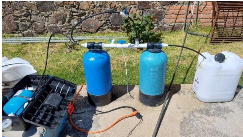
Figura 6.40. Operación del filtro de carbón activado
