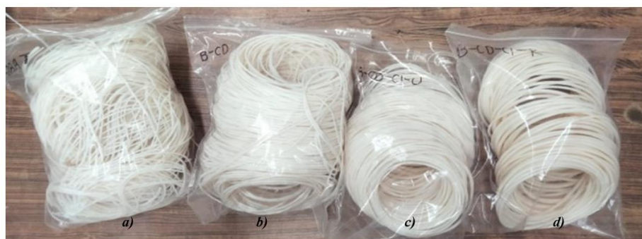
Figura 3.6 Filamentos obtenidos durante la extrusión a) PBAT b) PBAT-BCD c) PBAT-IC-U d) PBAT-IC-K.
