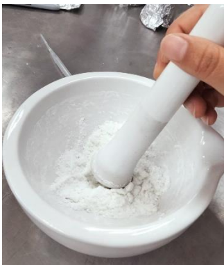
Figura 3.3 Método de amasado para la producción de los complejos de inclusión (IC-K)
