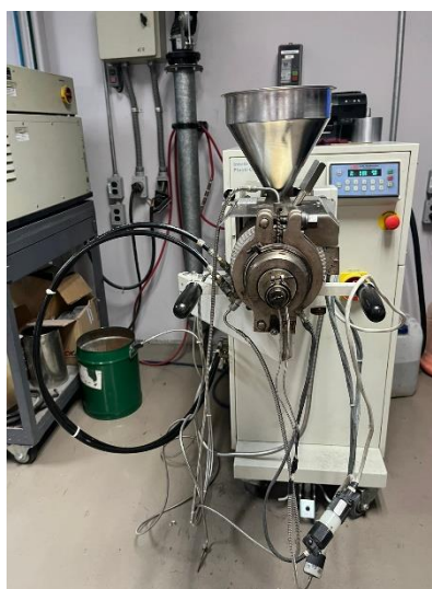
Figura 3.5 Extrusor de doble tornillo Brabender
