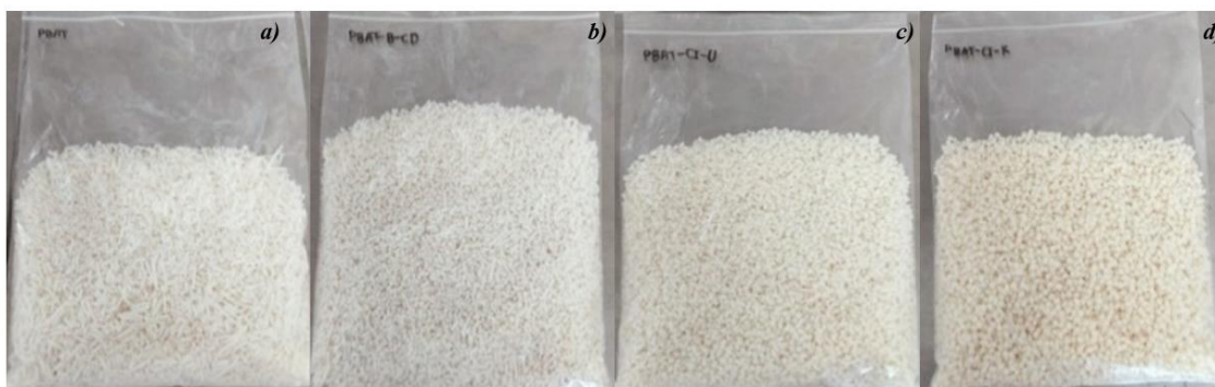
Figura 3.7 Pellets obtenidos de las muestras a) PBAT b) PBAT-BCD c) PBAT-IC-U d) PBAT-IC-K
