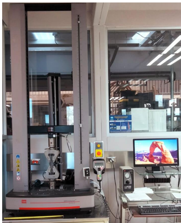
Figura 3.16 Máquina de ensayo de tracción Instron, modelo 4301
