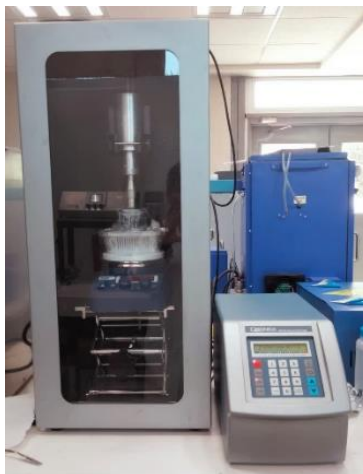
Figura 3.1 Equipo utilizado para la producción de complejos de inclusión por el método de ultrasonido.
