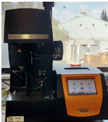
Figura 3.11 Equipo TGA Q500 (TA Instruments, EE. UU.)
