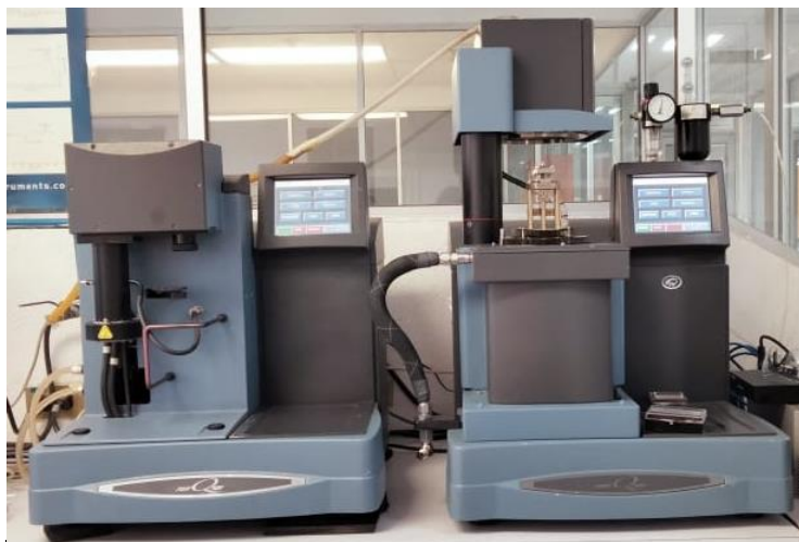
Figura 3.12 Equipo DSC-Q2000 (TA Instruments, New Castle, EE. UU.)
