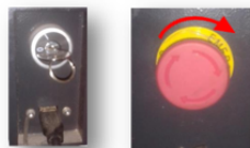
Figura 1.1 Interruptor principal y paro de emergencia
