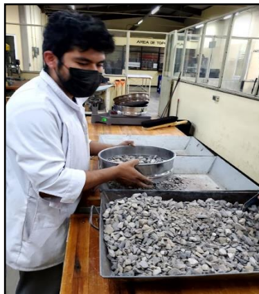
Imagen1.6 Cribado del agregado Grueso
