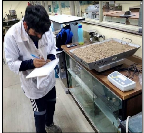
Imagen2.5 Peso obtenido de los agregados gruesos y finos
