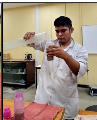
Imagen 7.3 llenado del biberón con arena hasta 4 ½ onzas
