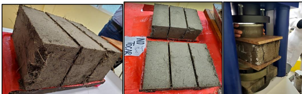
Figura 7. Tabicones adicionados con fibra de bagazo de maguey cuishe.
