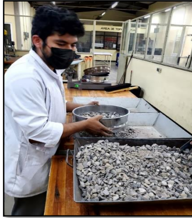
Imagen2.4 Cribado del agregado Grueso
