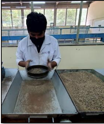
Imagen2.3 Cribado del agregado fino
