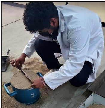
Imagen2.11 Enrasado del agregado fino
