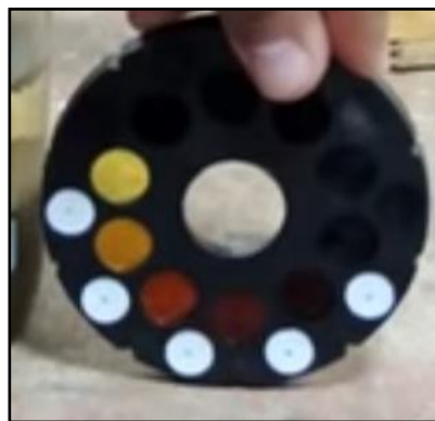
Imagen 7.5 resultados tras transcurrir 24 horas y comparación de colores por medio de un círculo cromático.
