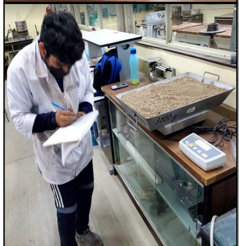
Imagen1.7 Peso obtenido de los agregados gruesos y finos
