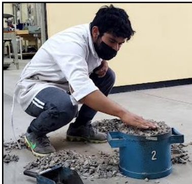
Imagen1.13 Enrasado del agregado grueso
