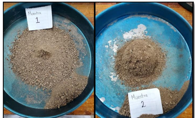
Imagen 6.4 muestra superficialmente seca
