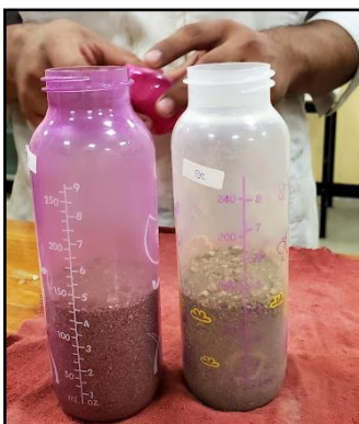
Imagen 7.3 llenado del biberón con arena hasta 4 ½ onzas
