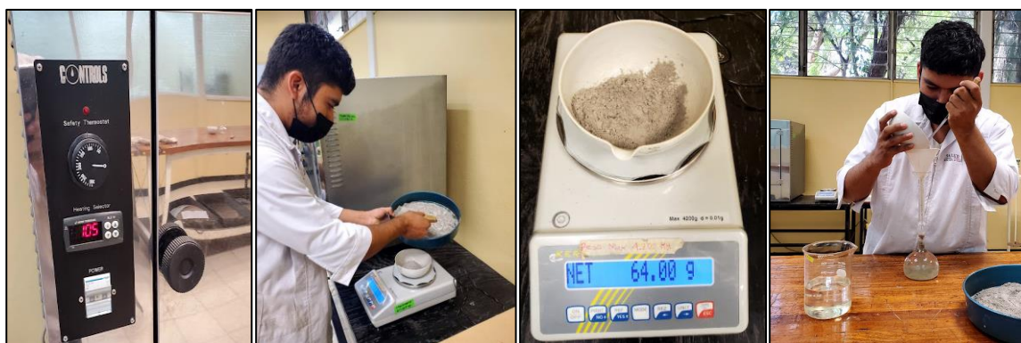
Imagen 9.2. preparación de la muestra de cemento y llenado de gasolina del frasco Le Chatelier asta 0 mililitros
