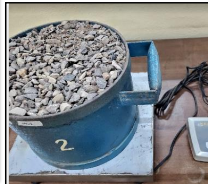
Imagen2.13 peso específico seco compacto de los agregados
