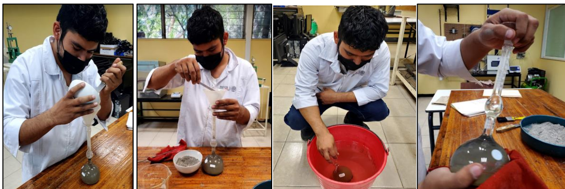
Imagen 9.3. incorporación de 64 grs. de cemento, sumersión a temperatura ambiente y rolamiento suave del matras Le Chatelier para expulsar las partículas de aire comprimidas.
