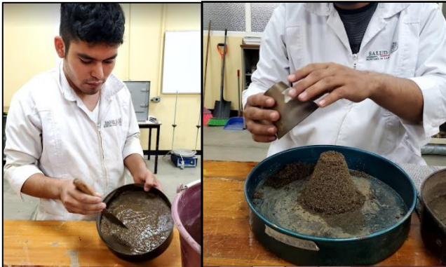
Imagen 6.3 muestra superficialmente húmeda
