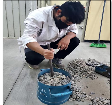
Imagen2.10 Aplicación de golpes de varilla
