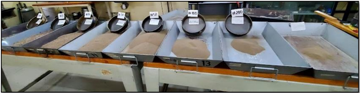
Imagen3.7 Colacacion de forma representativa de los cribados de los pesos de la arena.
