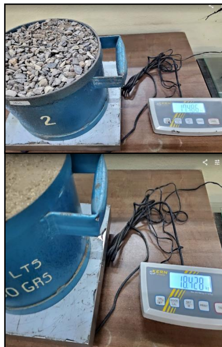
Imagen1.14 Peso específico seco suelto de los agregados finos y gruesos
