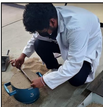
Imagen1.12 Enrasado del agregado fino
