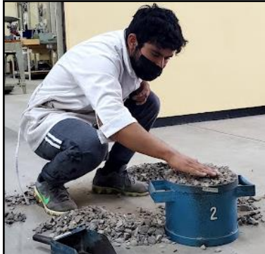
Imagen2.12 Enrasado del agregado grueso
