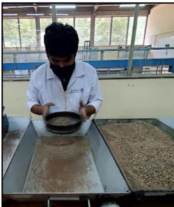
Imagen1.5 Cribado del agregado fino
