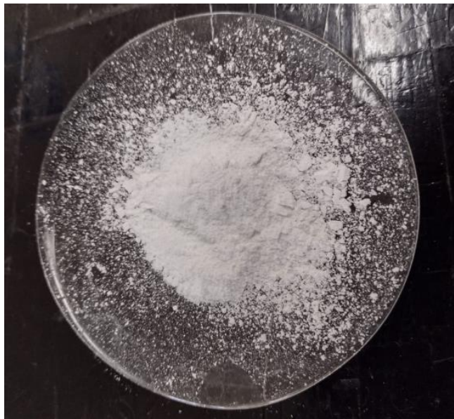
Figura 4.10 Semiconductor óxido de zinc (ZnO) utilizando como precursores nitrato de zinc hexahidratado ( \text{Zn}(\text{NO}_3)_2 \cdot 6\text{H}_2\text{O} ) e hidróxido de sodio (NaOH)
