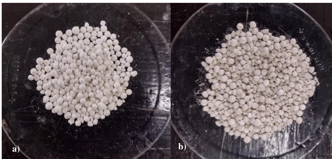
Figura 4.13 Catalizador obtenido Pt-ZnO/ Al 2 O 3 a) Precursor KOH, b) Precursor NaOH
