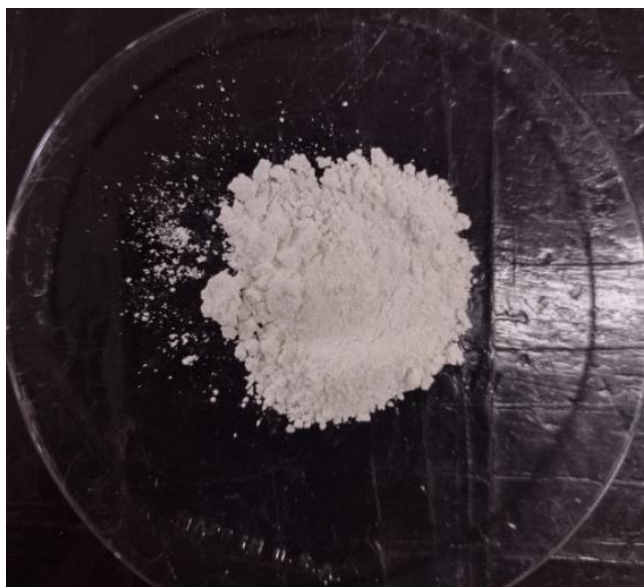
Figura 4.9 Semiconductor óxido de zinc (ZnO) utilizando como precursores nitrato de zinc hexahidratado (Zn (NO 3 ) 2 ·6H 2 O) e hidróxido de potasio (KOH)
