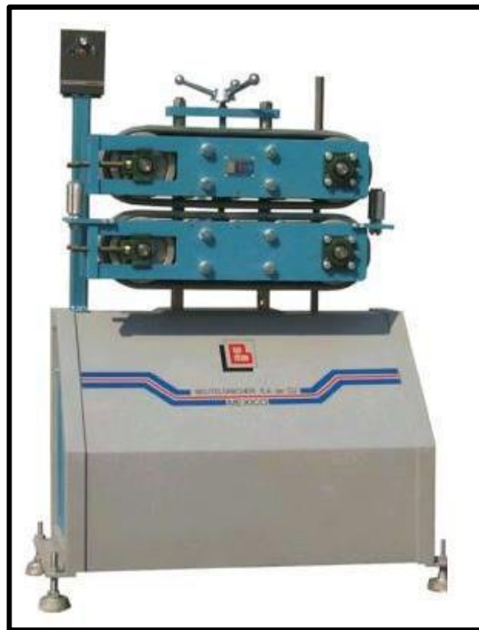
Figura 4.7 Jalador tipo oruga para perfiles (Comprado a BEUTELSPACHER S.A de C.V. ).
