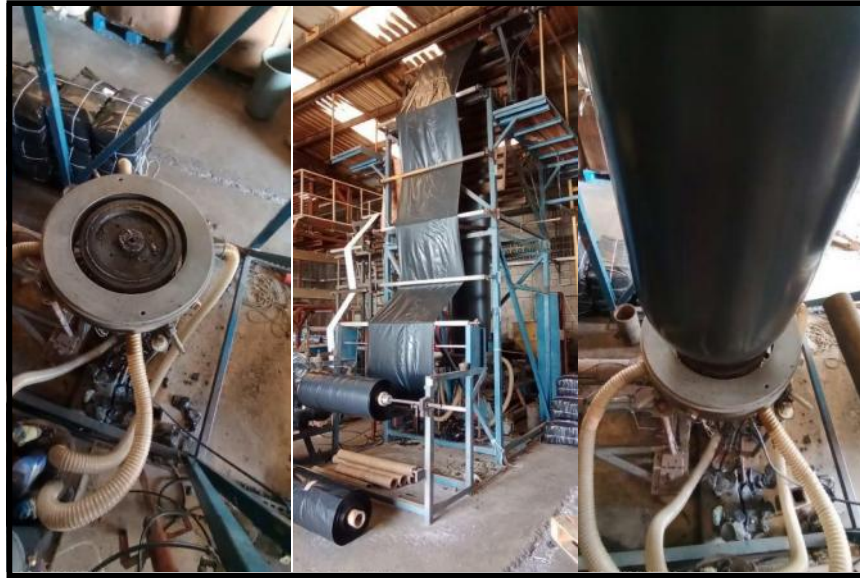
Figura 6.11 Proceso de fabricación de bolsas para desechos negras: a) dado anular, b) burbuja en detalle y c) proceso global. Fotos proporcionadas por VASA, S.A de C.V.
