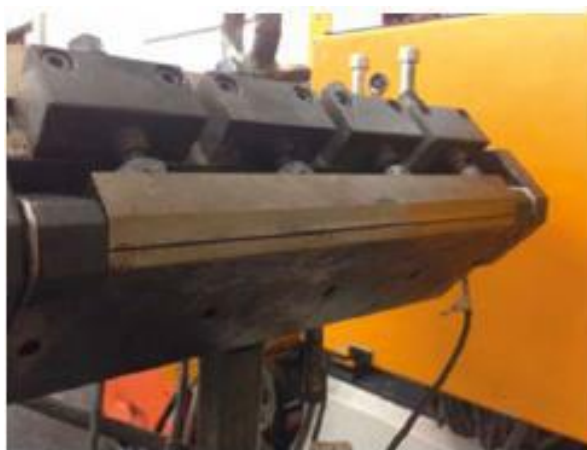
FOTOGRAFIA DE UN DADO TIPO GANCHO DE ROPA PARA PELICULA PLANA
