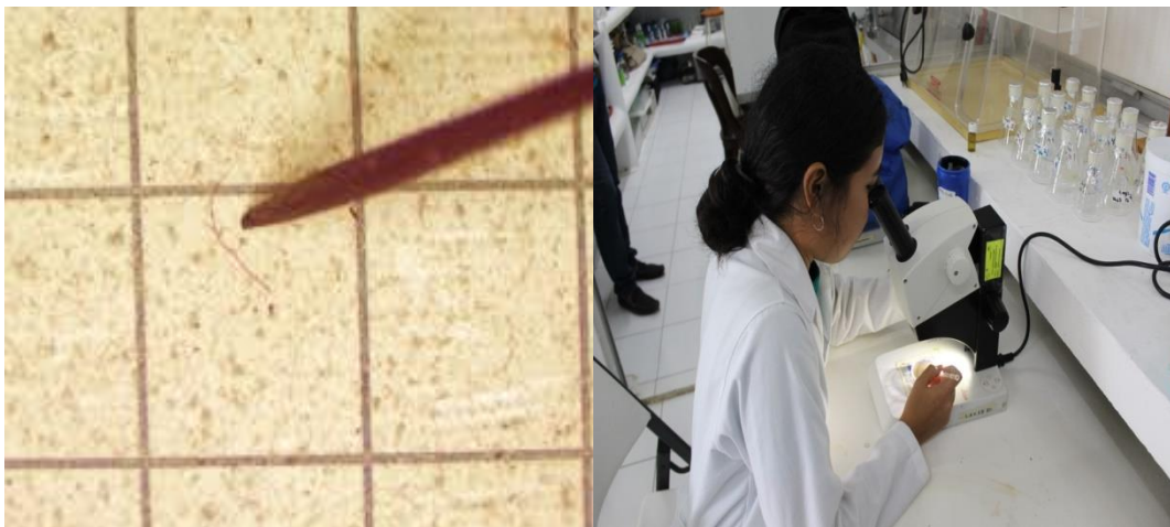
Figura 5. Análisis de laboratorio. Separación de partículas de microplásticos en muestras obtenidas
