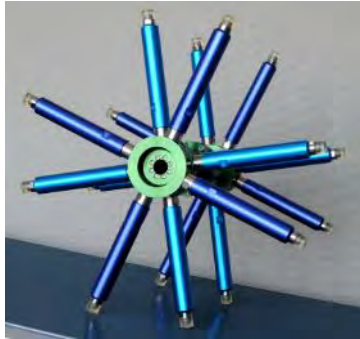
Figura 2.12 Andador pasivo dinámico con forma de radio con dos marcos cruzados [15].
