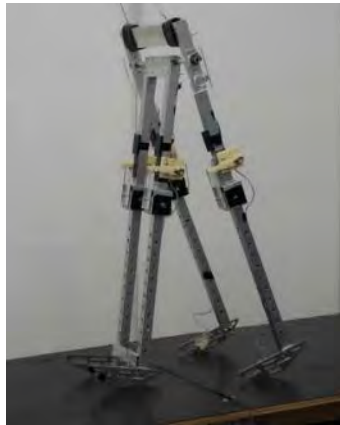
Figura 2.10 Andador de cuatro patas con mecanismo de bloqueo activo de rodilla [14].
