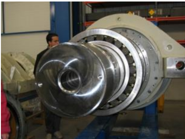
Ilustración 9. Eje principal que va del eje lento a la multiplicadora
