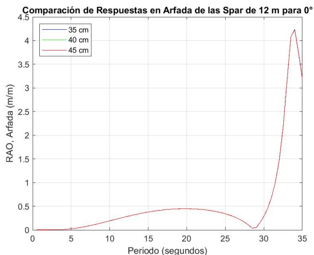
Figura 8-2. Comparación de respuestas en arfada de las spar de 12 m para 0°.
