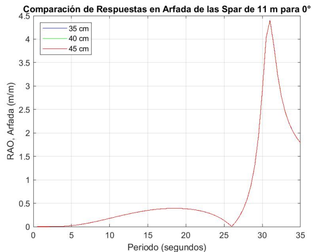
Figura 8-1. Comparación de respuestas en arfada de las spar de 11 m para 0^\circ .
