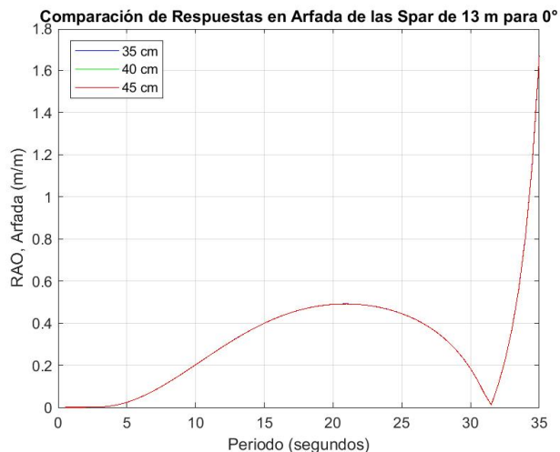
Figura 8-3. Comparación de respuestas en arfada de las spar de 13 m para 0°.
