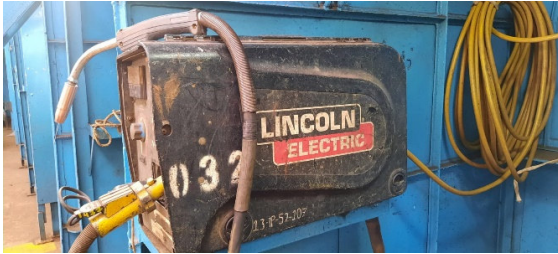
Fig. 7A Habilitación de equipos requeridos para las pruebas (Alimentador de Alambre LN-25).
