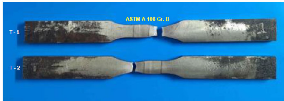
Fig. (A) Prueba de Tensión
