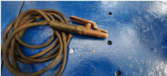
Fig. 7C Habilitación de equipos requeridos para las pruebas (Porta electro ).
