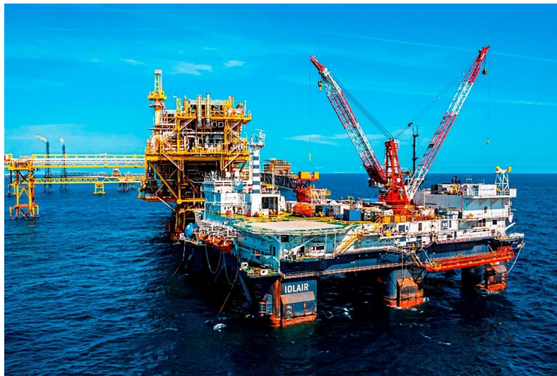
Figura 7. Plataforma Semisumergible Flotel IOLAIR realizando trabajos a plataforma fija. (WIKIPEDIA, 2021)
