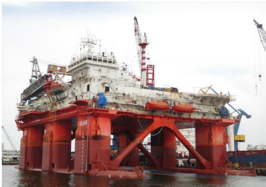
Figura 21. Plataforma Semisumergible tipo “Flotel”. (Traffic, 2007)
