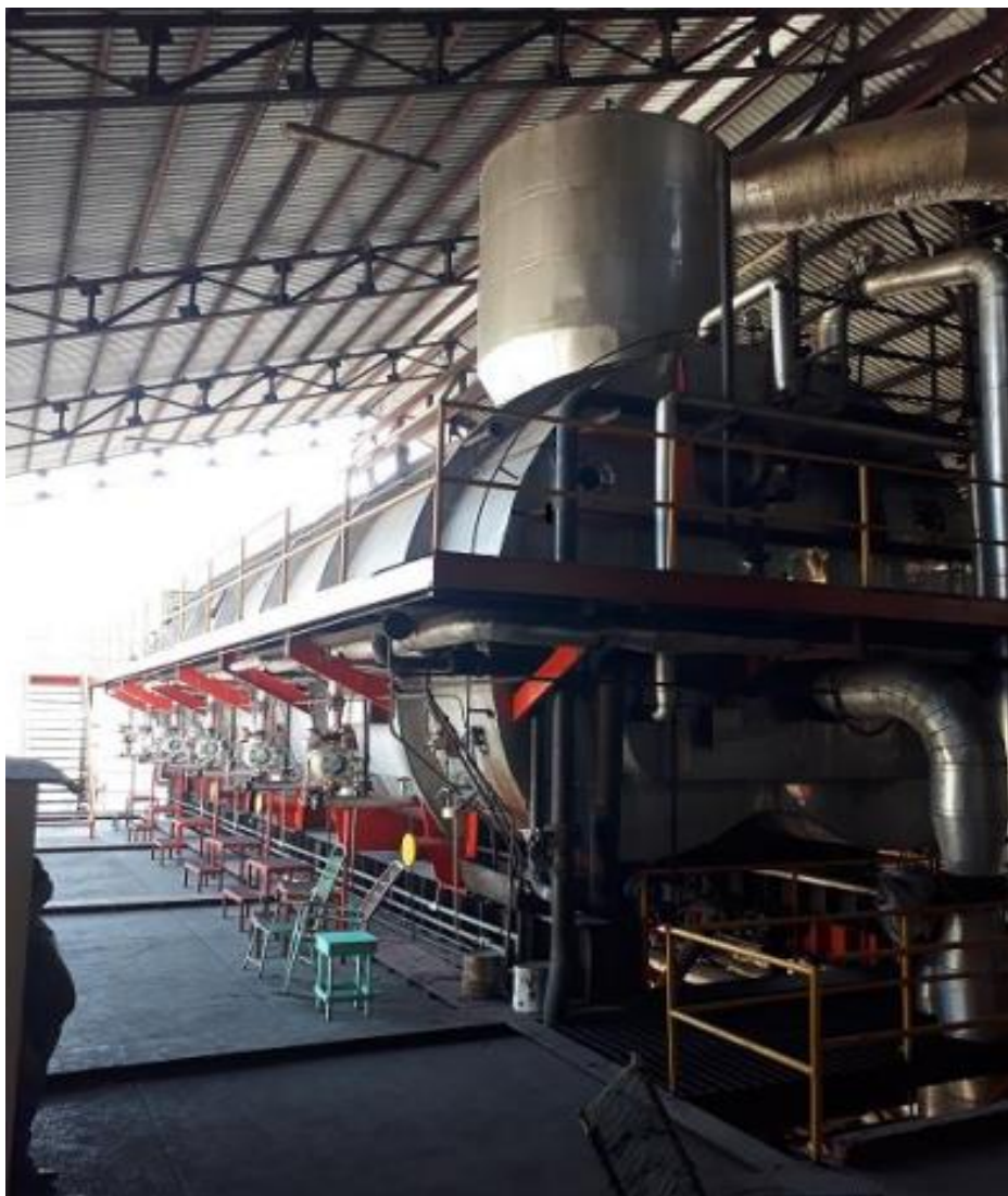
Figura 7. Tachos para cristalización del grano de azúcar en el Ingenio Central Motzorongo.
