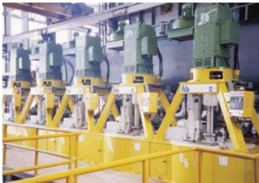
Figura 8. Cristalizador de masa cocida en el Ingenio Central Motzorongo.
