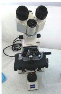
Ilustración 7. Microscopio óptico marca ZEISS Axiostar (1122- 100), empleado para el conteo celular.
