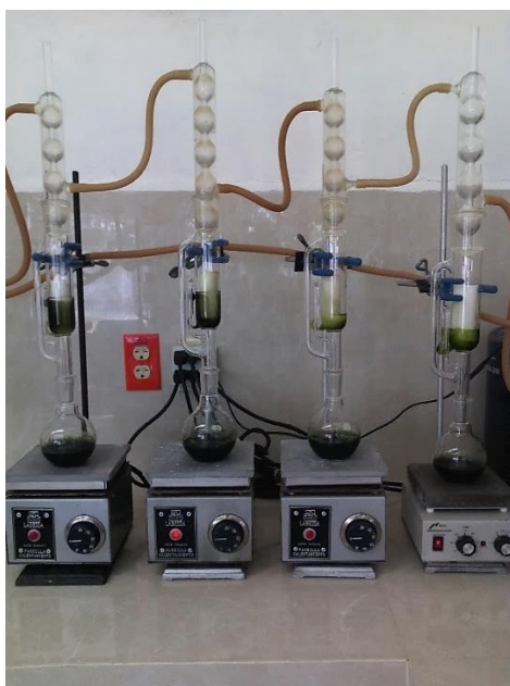
Ilustración 9. Extracción de lípidos por método Soxhlet.
