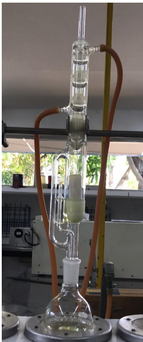
Ilustración 24. Equipo soxhlet completamente montado ya con cartucho, muestra, y éteres puestos.
