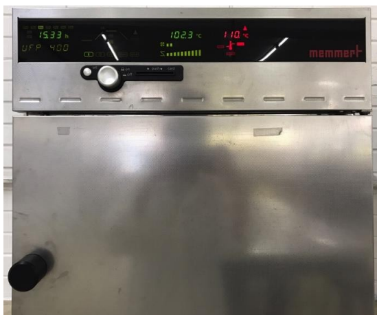
Ilustración 18. Estufa configurada a 105 grados centígrados para secado de muestra.
