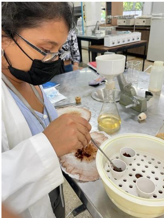
Figura 35. Adición de muestra lavada en crisoles
