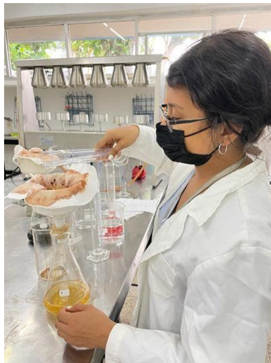
Figura 34. Lavado con ácido, agua y alcohol etílico
