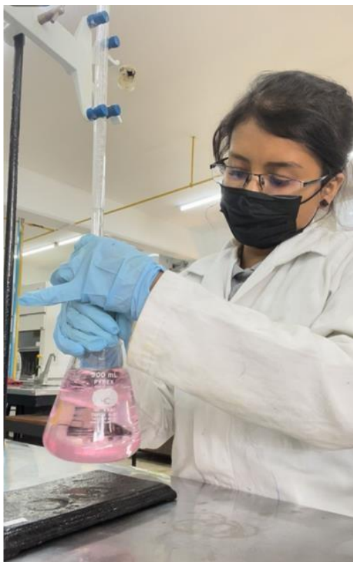
Figura 21. Titulación del destilado hasta vire
