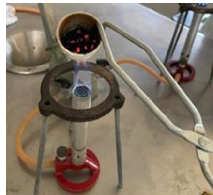
Figura 12. Calcinación a flama directa con mechero Bunsen hasta punto rojo
