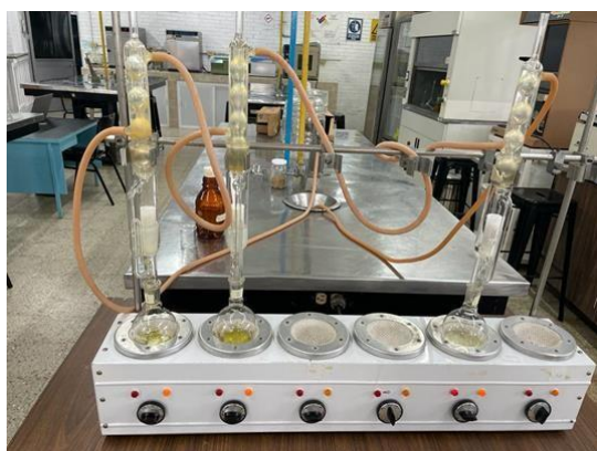
Figura 25. Puesta en marcha del equipo Soxhlet
