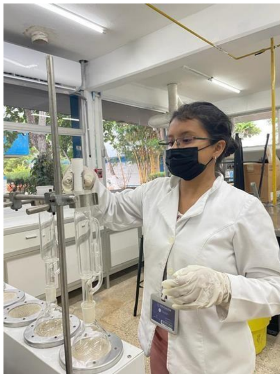
Figura 24. Adición de cartucho con muestra al Soxhlet
