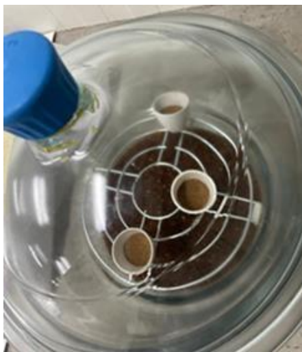
Figura 11. Muestras para determinación de humedad en desecador
