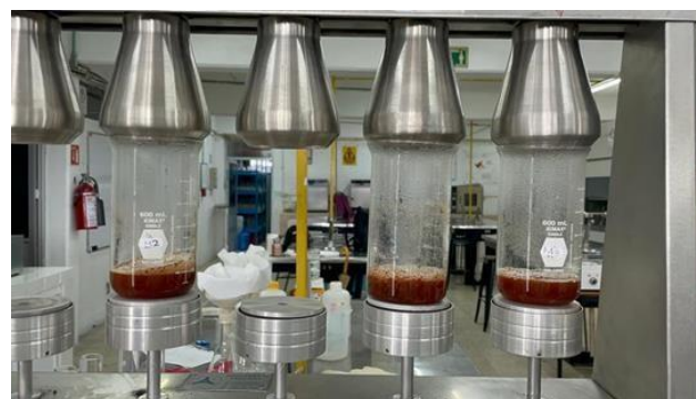
Figura 30. Puesta en marcha de digestor: digestión ácida
