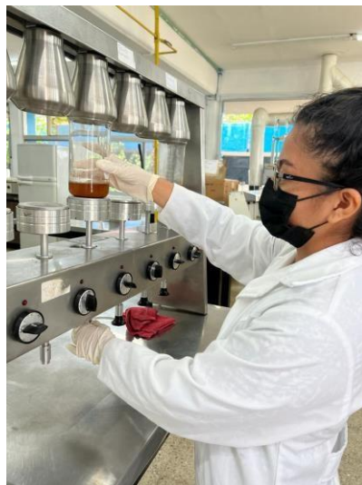
Vaso Berzelius en el aparato sobre la placa caliente.
