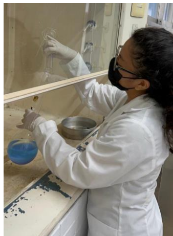
Después de la digestión, matraz Kjeldahl con agua destilada, granallas de Zinc y NaOH.
