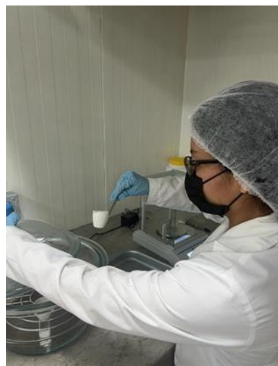
Peso de muestras en crisoles hasta peso constante.
