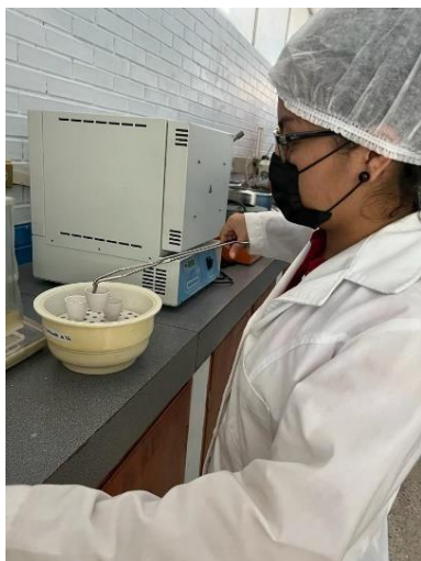
Enfriar crisoles con muestra carbonizada en el desecador.
