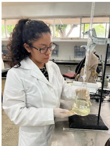
Titulación del destilado con NaOH al 0.1%
