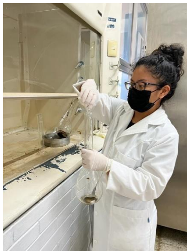
Matraz Kjeldahl con muestra, sulfato de cobre pentahidratado, sulfato de sodio anhidro y ácido sulfúrico concentrado de acuerdo a las cantidad de la metodología.
