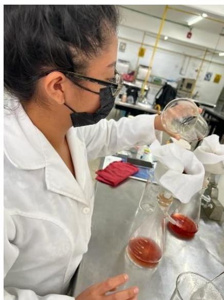
Filtrado con tela de lino y lavado hasta obtener pH neutro con NaOH, ácido sulfúrico, alcohol etílico.
