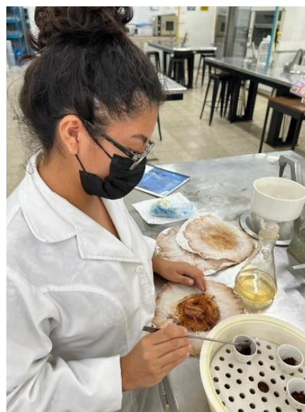
Residuos transferidos a crisoles a peso constante para secar.
