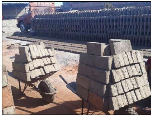
Ilustración 17. Carga y transporte del ladrillo al horno. Fuente: Elaboración Propia
