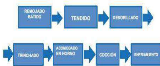
Ilustración 8. Etapas del proceso de elaboración del ladrillo. (Guía de buenas prácticas para ladrilleras artesanales, 2010).
