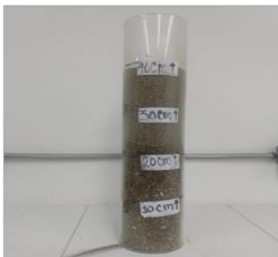
Figura 2. Tubos de acrílico con diferentes alturas de lecho.
