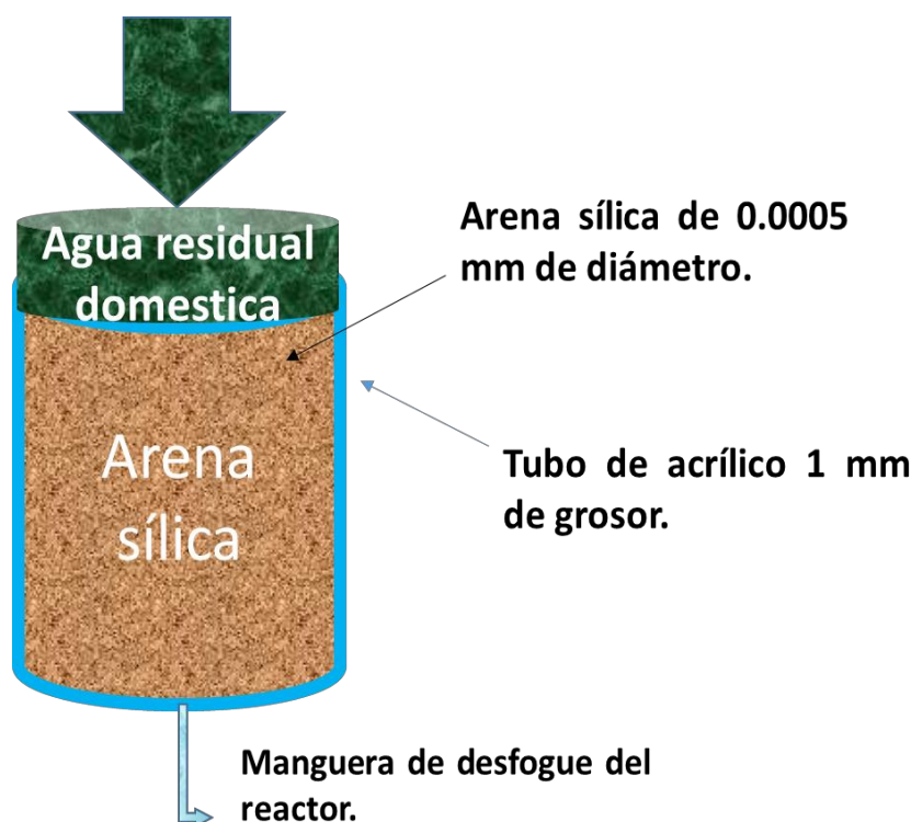
Figura 13. Componentes del reactor de arena
