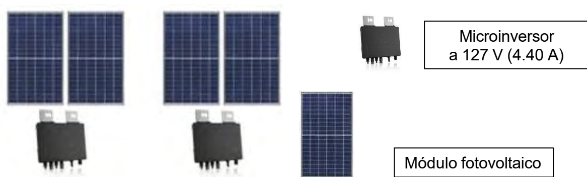
Figura 18. Configuración de los microinversores respecto a los módulos fotovoltaicos, nivel de tensión 127 V.
