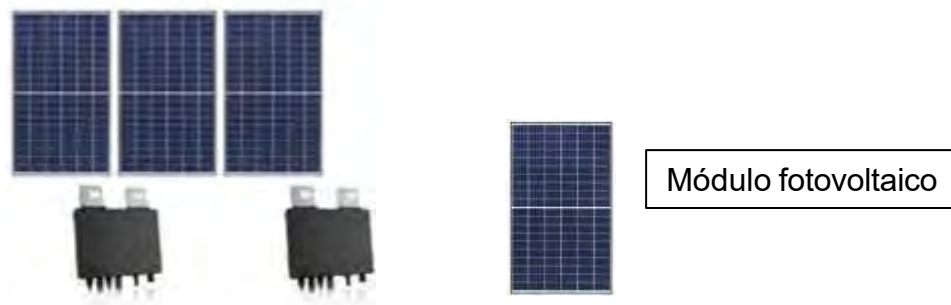
Figura 16. Configuración de los microinversores respecto a los módulos fotovoltaicos, nivel de tensión 127 V.
