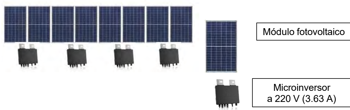
Figura 17. Configuración de los microinversores respecto a los módulos fotovoltaicos, nivel de tensión 220 V.
