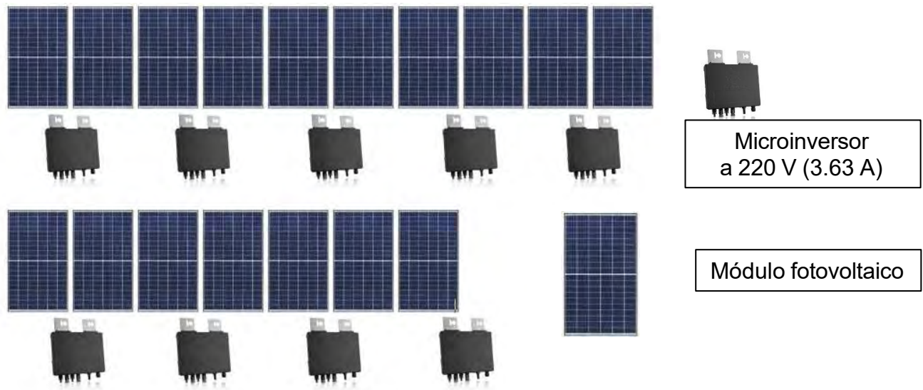
Figura 15. Configuración de los microinversores respecto a los módulos fotovoltaicos, nivel de tensión 220 V.
