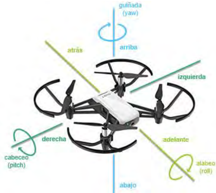
Figura 4.13 Movimientos que permite ejecutar el VANT
