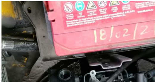
Figura 4-13. Fecha escrita del cambio de batería por los técnicos
