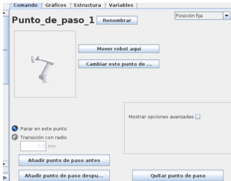
Imagen 8. 6 Pantalla para la edición del punto de paso del brazo
