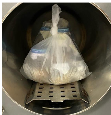
Imagen 20. Frascos en autoclave para esterilizar Fuente: propia (2023).
