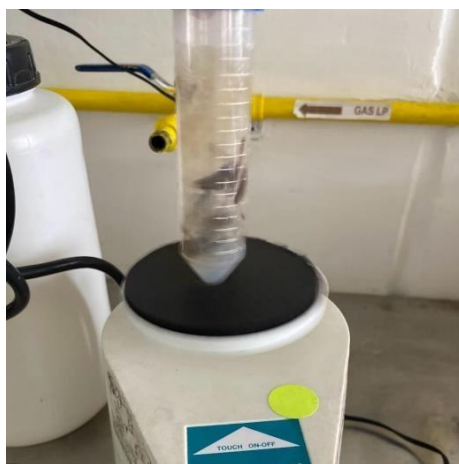
Imagen 22. Agitación de sustrato para el desprendimiento de esporas Fuente: propia (2023).
