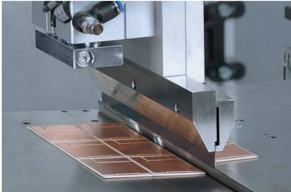
Figura 3.17 Cuchilla de robot y mecanismo de mesa cortando una tira de DBC [14]
