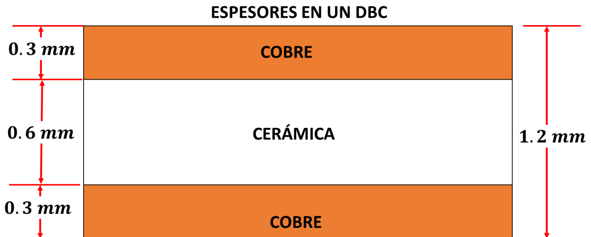
Figura 3.15 Espesores de un DBC. El espesor total es de 1.2 \text{ mm}
