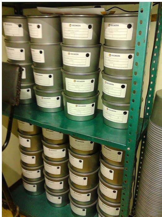
Figura 27. Almacenamiento temporal de tintas UV. Elaboración propia.
