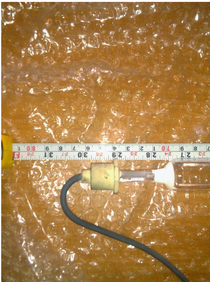
Figura 26. Medición de conector de lámpara UV. Elaboración propia.
