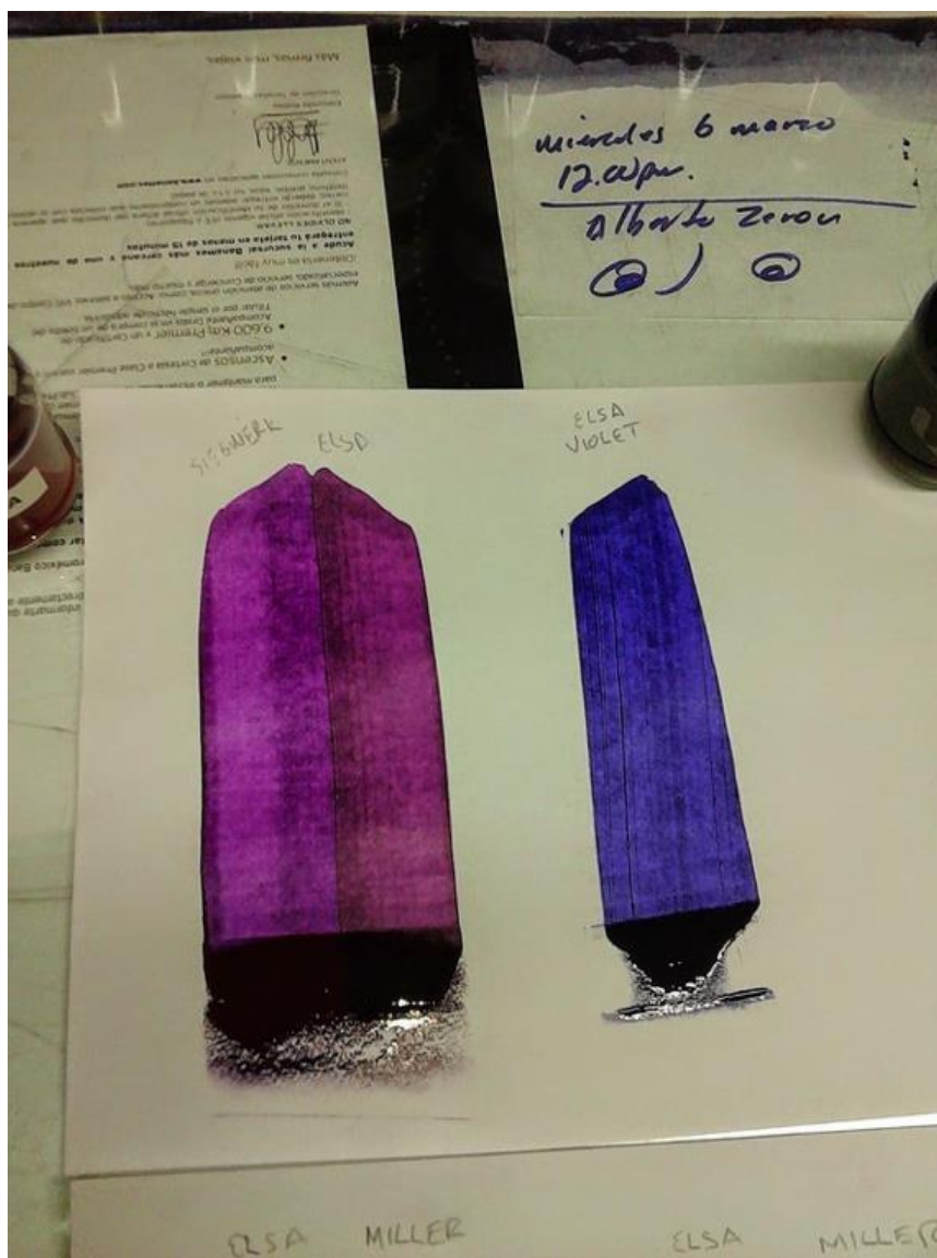
Figura 29. Prueba e igualación de tintas UV. Elaboración propia.
