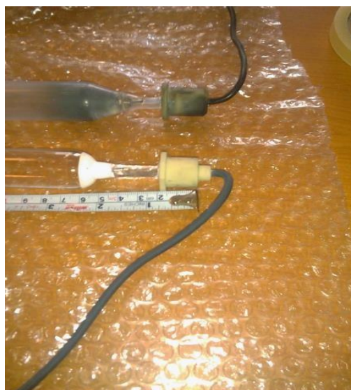
Figura 23. Toma de medida de conector de lámpara UV. Elaboración propia.
