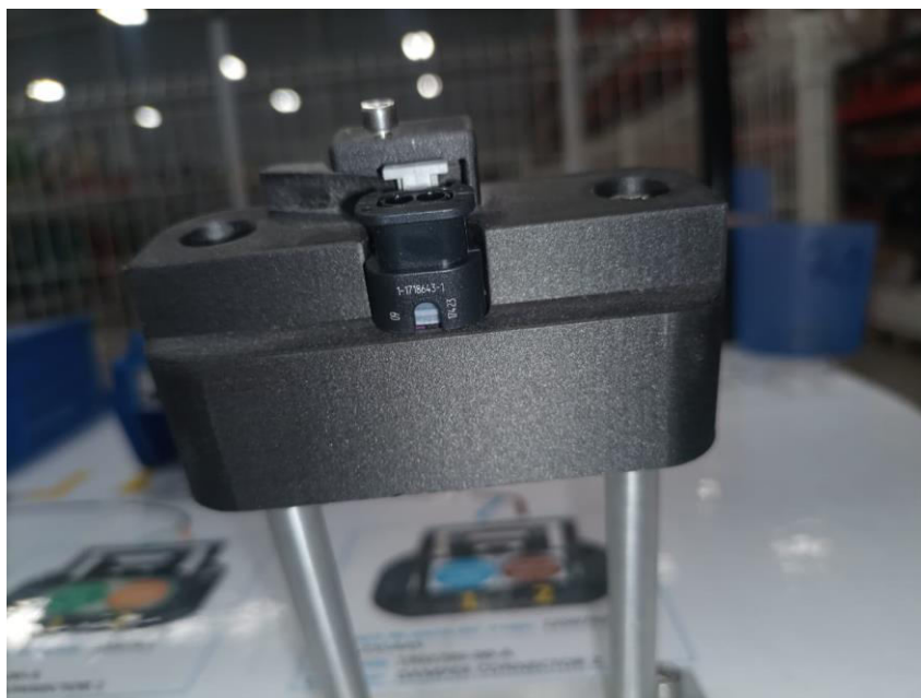
Ilustración 34 Fixtura mal diseñada del arnés frontal
