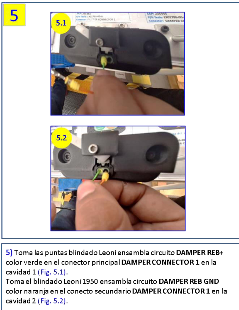
Ilustración 86 Nueva actividad 5 de preensamble 1 arnés trasero
