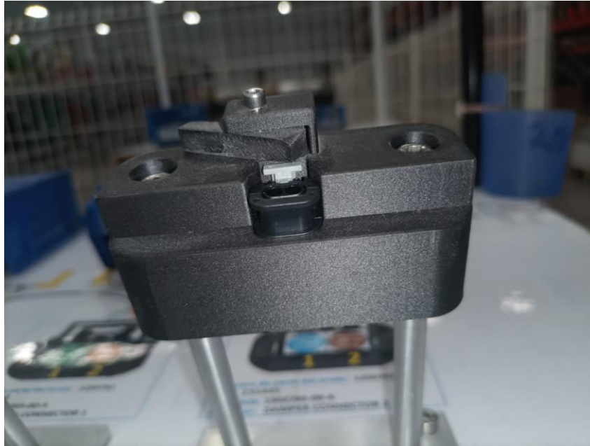
Ilustración 19 Fixtura diseñada correctamente para el arnés trasero
