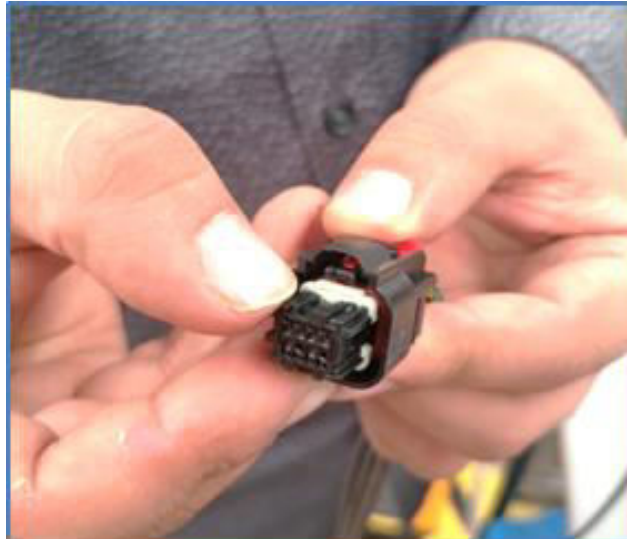
Ilustración 41 Ejemplo del cierre del candado del WSS ACCELEROMETER CONNECTOR
