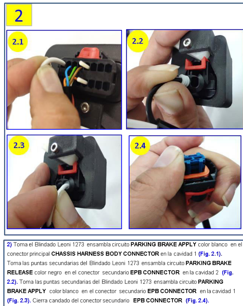
Ilustración 55 Actividad 2 de preensamble 2 arnés trasero
