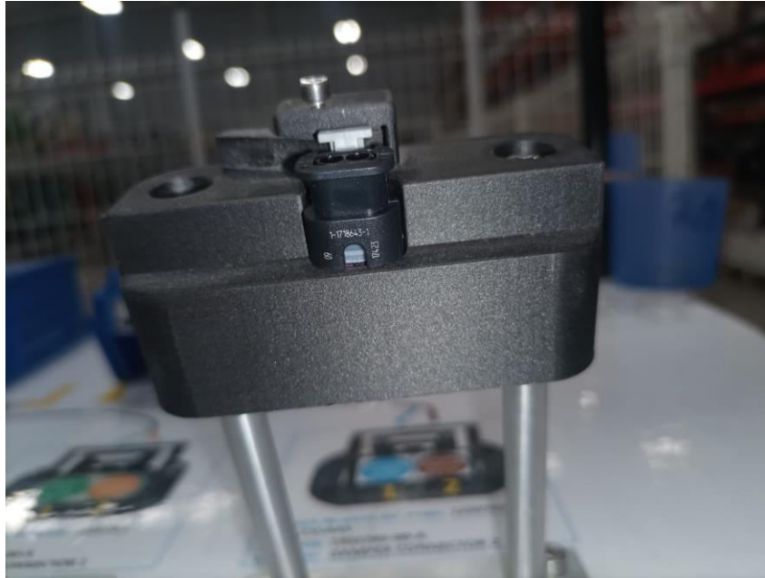
Ilustración 17 Fixtura mal diseñada del arnés trasero
