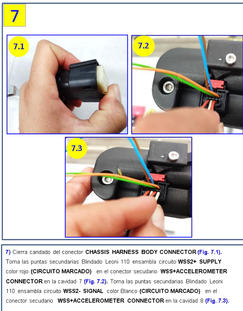
Ilustración 77 Actividad 7 de preensamble 2 arnés frontal
