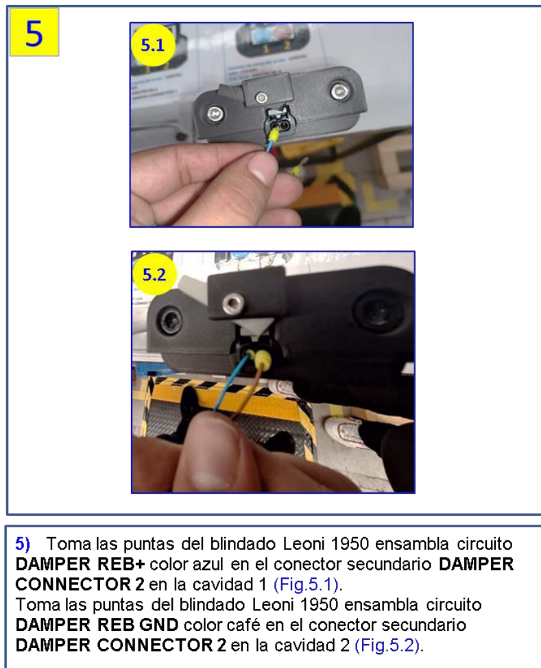
Ilustración 107 Nueva actividad 5 del preensamble 1 del arnés frontal
