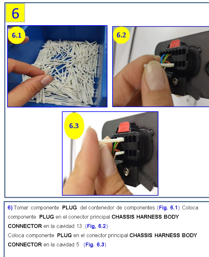
Ilustración 52 Actividad 6 de preensamble 1 arnés trasero
