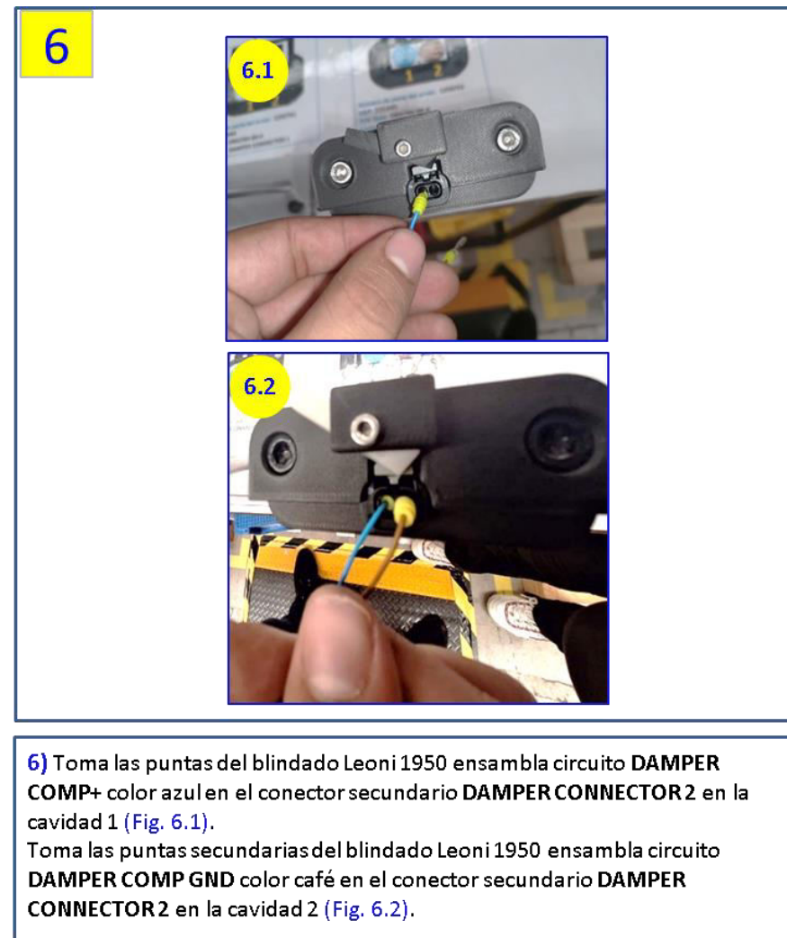
Ilustración 87 Nueva actividad 6 de preensamble 1 arnés trasero
