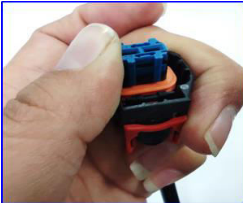
Ilustración 27 Ejemplo del cierre del candado del EPB CONNECTOR
