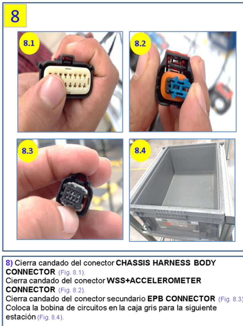
Ilustración 25 Solución del cierre del candado del CHASSIS HARNESS BODY CONNECTOR del arnés trasero
