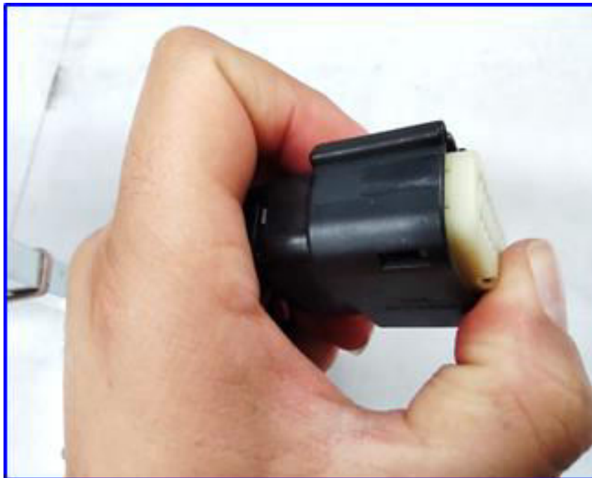
Ilustración 24 Ejemplo del cierre del conector principal
