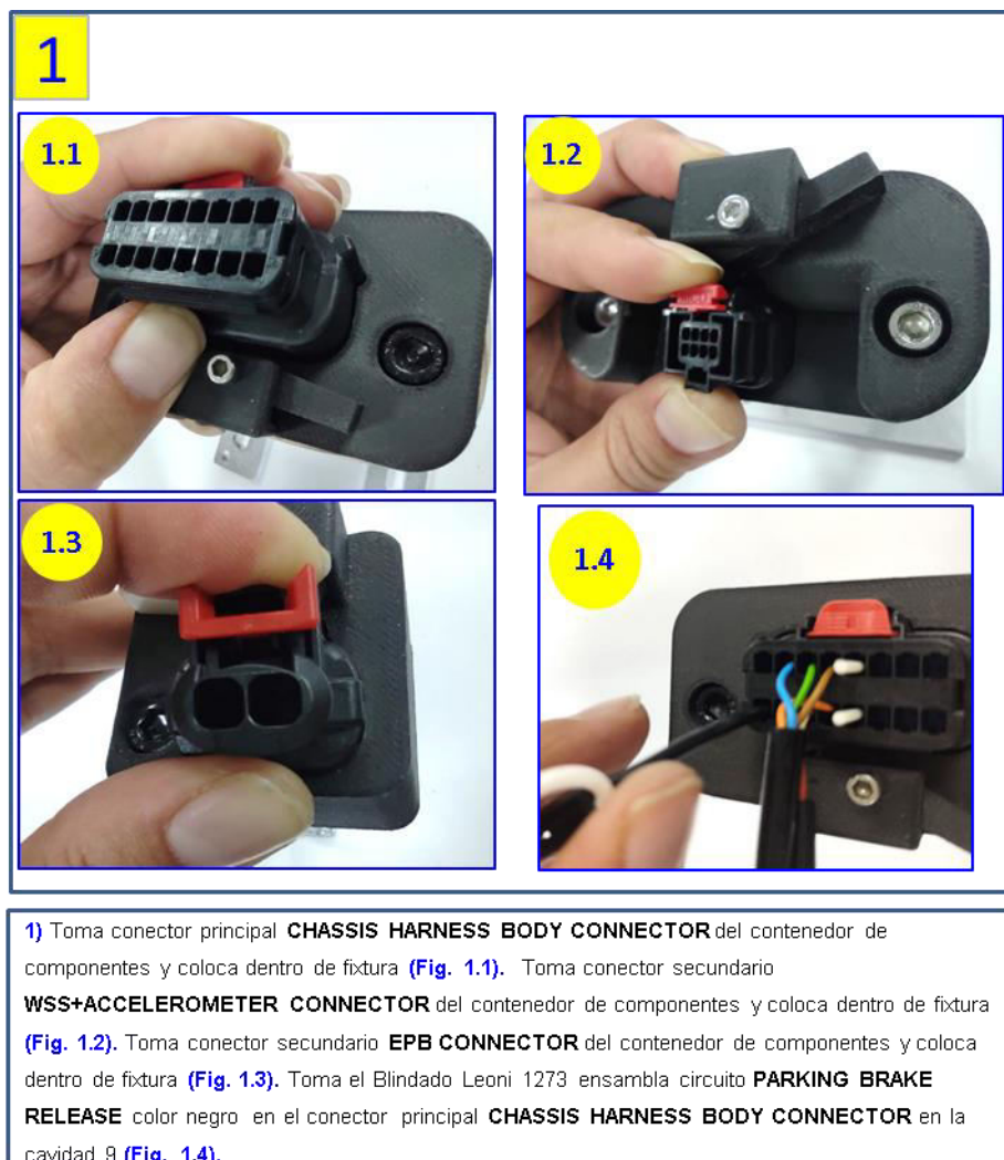
Ilustración 54 Actividad 1 de preensamble 2 arnés trasero
