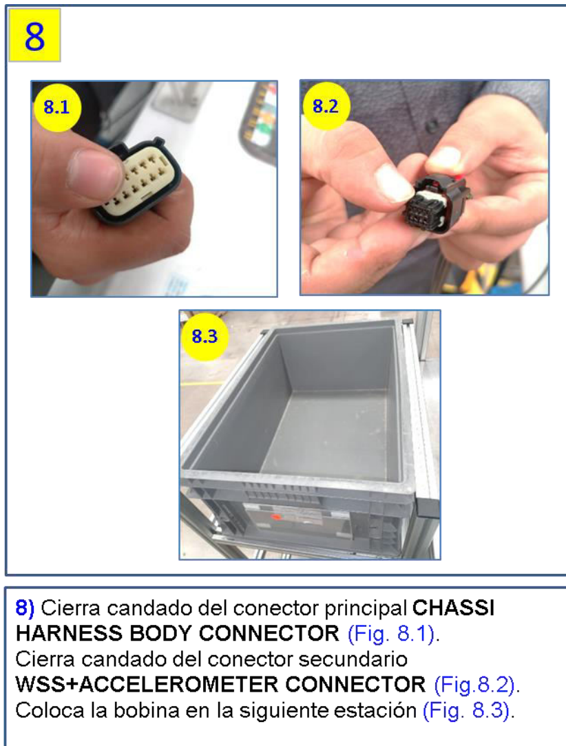
Ilustración 42 Solución del cierre del candado del WSS ACCELEROMETER CONNECTOR del arnés frontal
