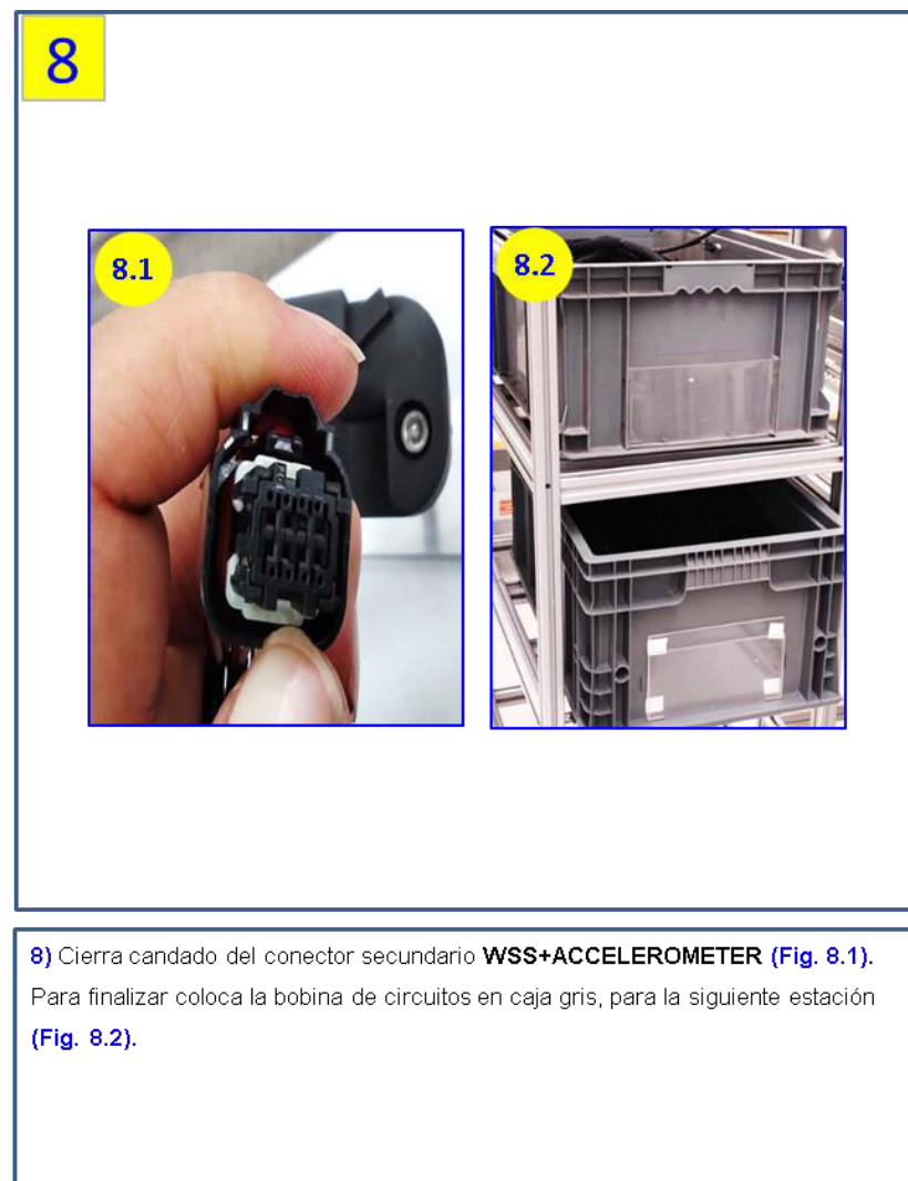
Ilustración 78 Actividad 8 de preensamble 2 arnés frontal
