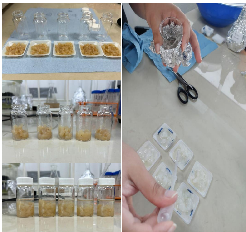
Figura 2.4 Impregnado de las películas con solución de nitrato de plata.
