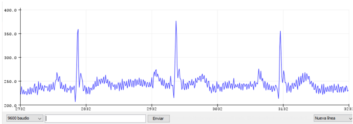
Figura 3.3: Lectura de la tarjeta de adquisición AD8232 (serial plotter)
