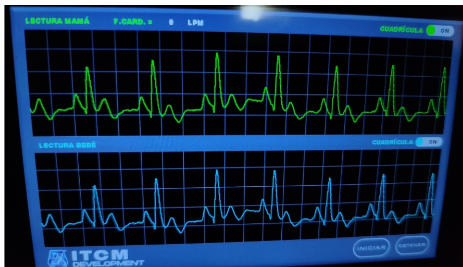
Figura 4.29: ECG visualizado en tiempo real (ESP32)
