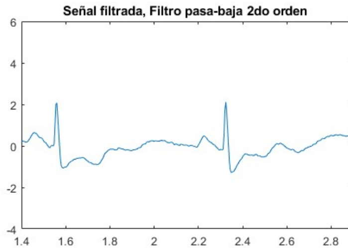
Figura 3.13: Señal con acción del filtro
