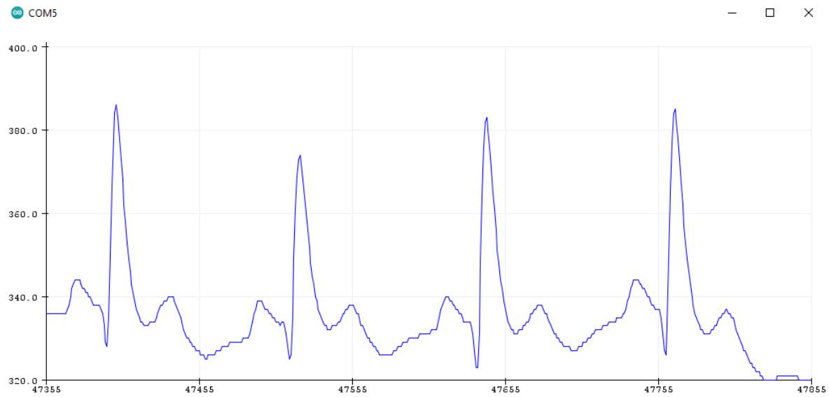
Figura 3.16: Señal con acción del filtro pasa-bajas a 20 Hz
