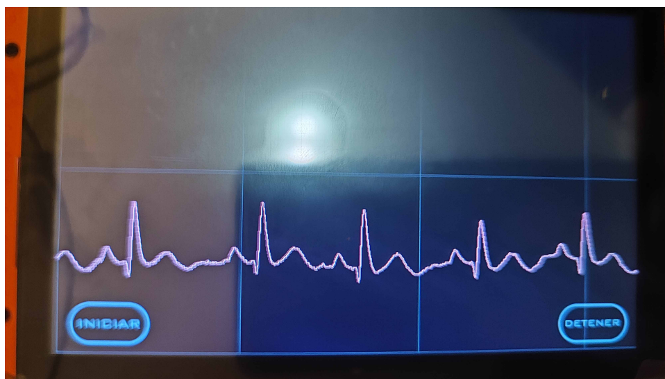
Figura 4.13: ECG con filtro pasa-bajas a 35 Hz (Nextion)
