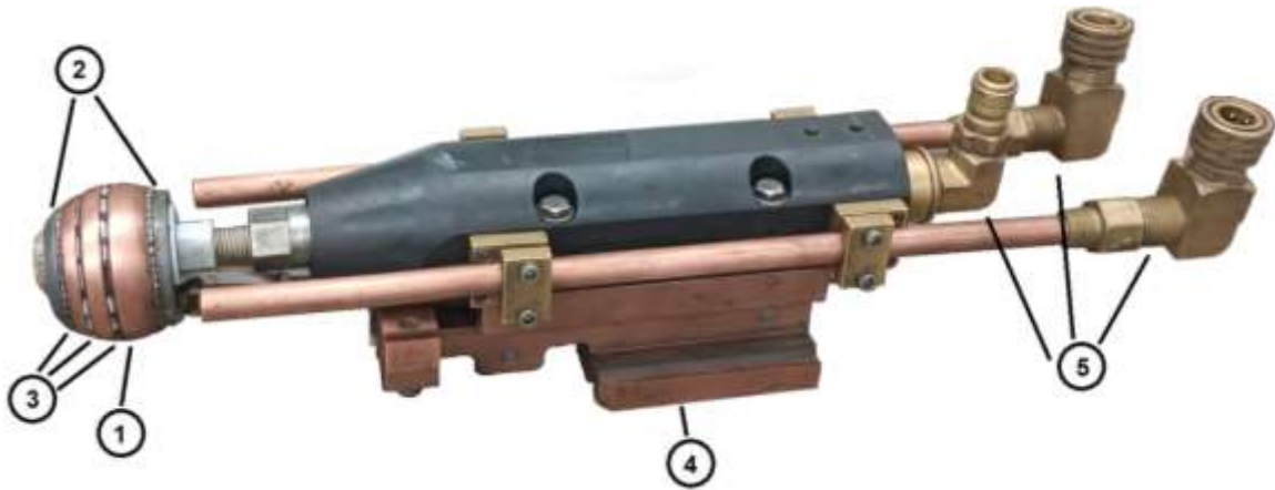
Figura 3.8 Ensamble de inductor, dispuesto para ser llevado a la máquina de temple.
