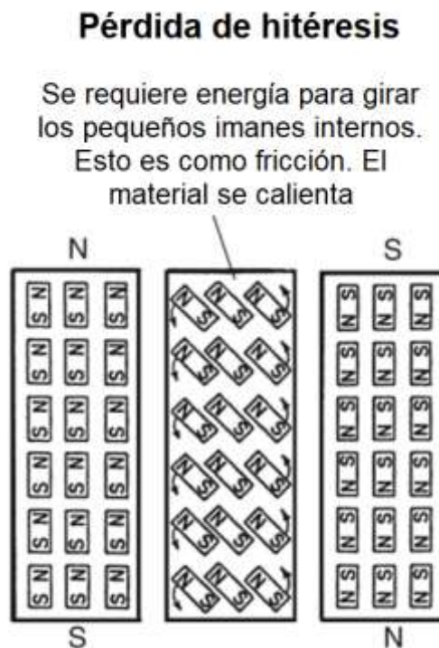
Figura 2.9 Efecto de la histéresis en la velocidad de calentamiento. N: norte; S: sur, en un material ferromagnético.
