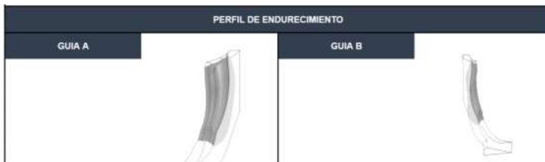
Figura 4.6 Perfil de endurecimiento para dos tipos de guías de una junta fija.
