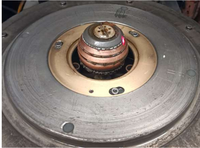
Figura 4.9 Inductor montado, dispuesto para el tratamiento térmico.
