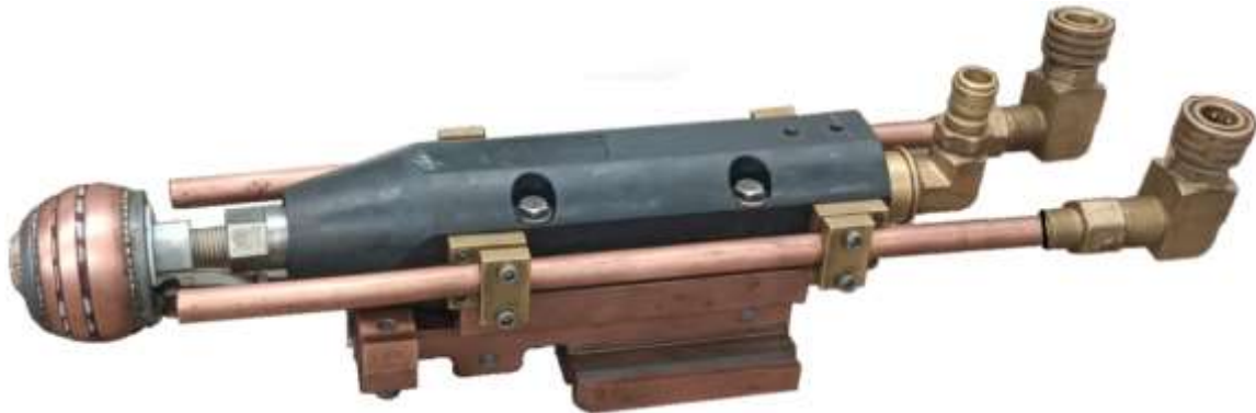
Figura 4.8 Ensamble del inductor para temple por tratamiento térmico.
