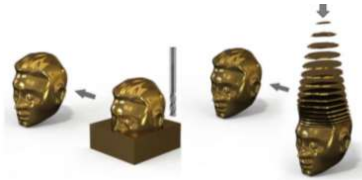
Figura 2.14 comparación entre manufactura convencional y manufactura aditiva.
