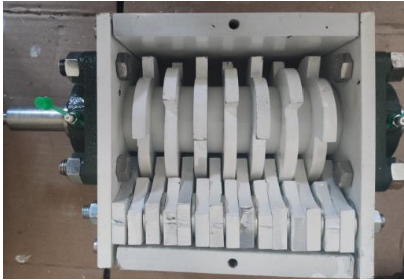
Figura 3.39 Caja de trituración ensamblada.
