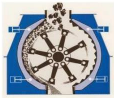
Figura 1.1 Molino de martillos [1].
