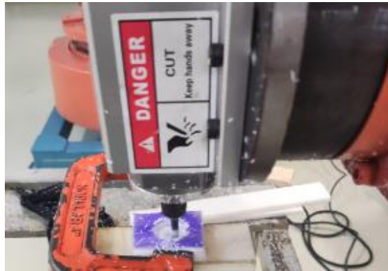
Figura 3.34 Maquinando el hexágono.
