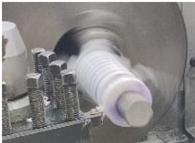
Figura 3.35 Redondeando el separador.
