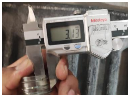
Figura 3.4 Medida en la boca de la botella.
