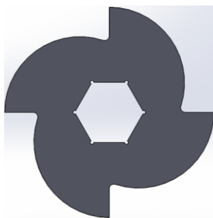
Figura 3.13 Cuchilla con 4 navajas.
