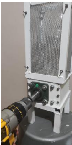
Figura 4.11 Pruebas de trituración con el taladro.
