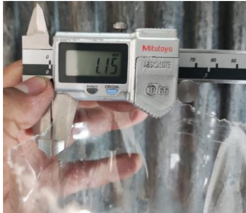
Figura 3.6 Medida en la pared de la botella.
