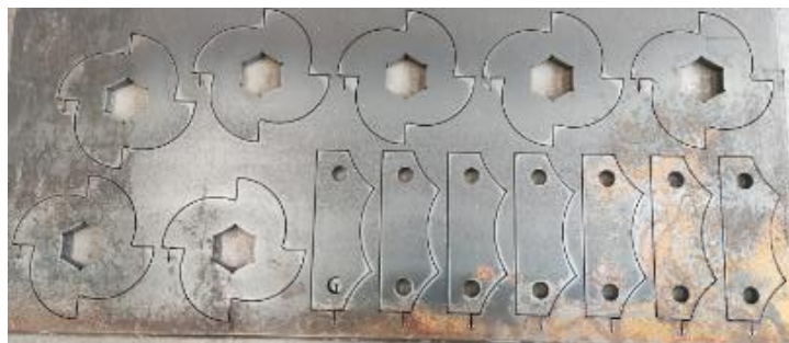
Figura 3.33 Corte por láser de material.
