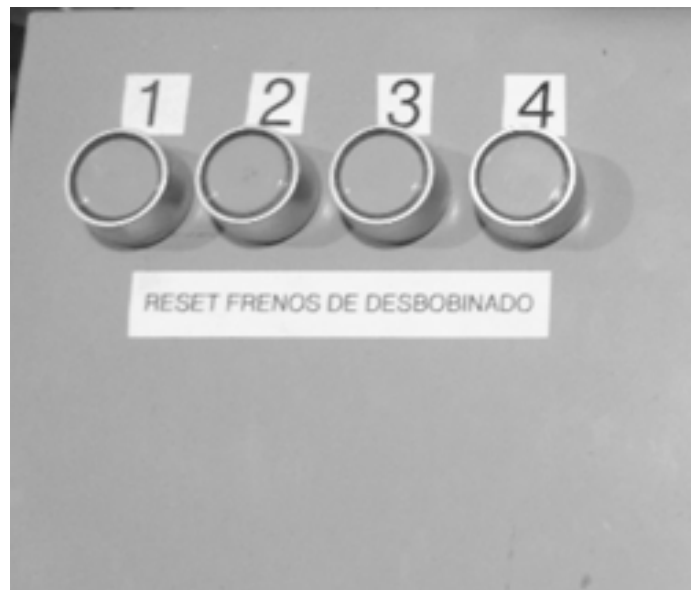
Figura 4.30 Pulsadores de reinicio de diámetro de rollos.
