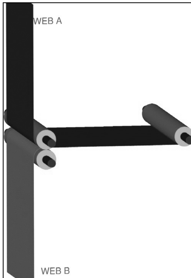
Figura 2.6 Bandas alineadas antes del corte
