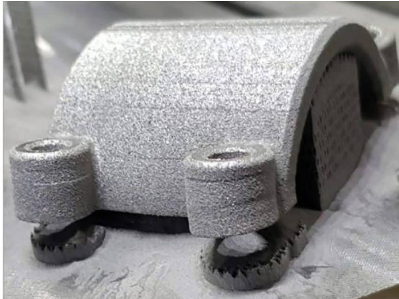
Figura 2.5 Efecto de deformación en pieza impresa [1]
