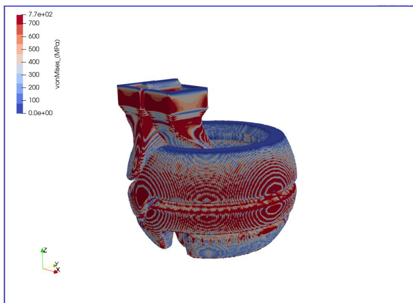
Figura C8. Resultado grafico de esfuerzos residuales para simulación número 8
