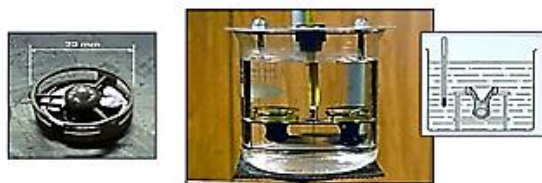
Figura 2.4 Análisis ring & ball en muestra de asfalto
