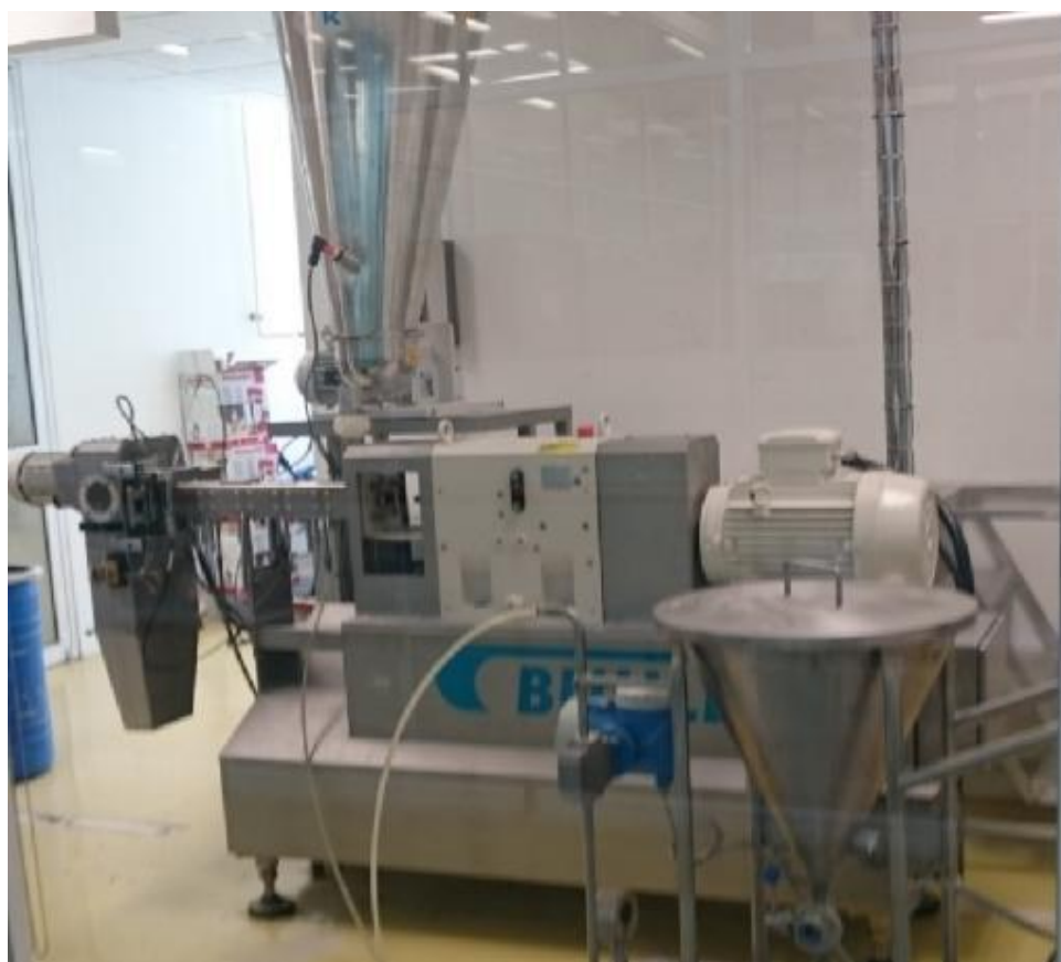
Figura 2. Equipo utilizado para los pretratamientos: extrusor de doble tornillo BTSM (Bühler, Suiza), tolva de alimentación de sólidos (K-Tron, Suiza) y bomba de alimentación de líquidos (Bühler, Suiza).
