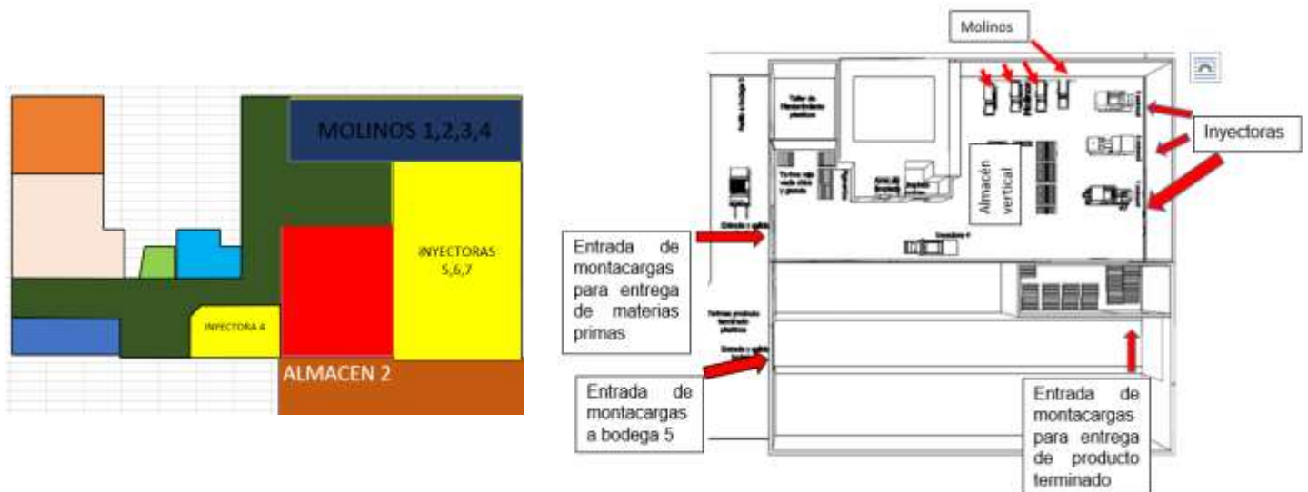
Ilustración 39 Descripción del proceso de producción de plásticos y descripción de nuestro diseño rustico de propuesta de almacén
