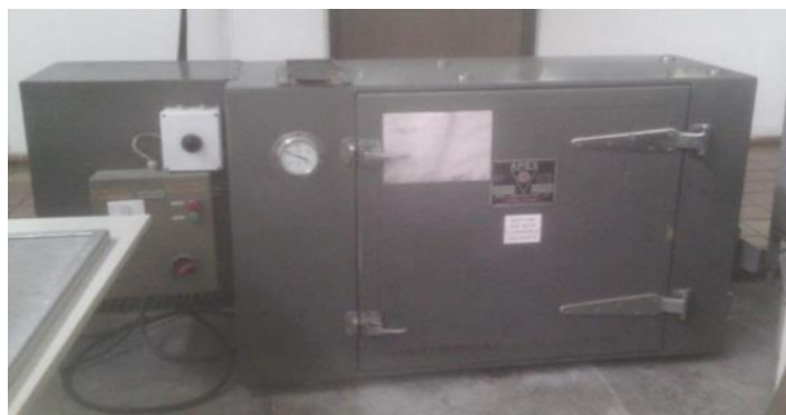
Figura 22. Secador de charolas o bandejas marca APEX®, serie A 39854-14. Fuente: propia
