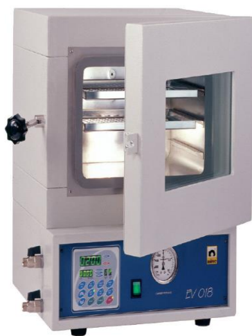
Figura 18. Estufa al vacío para determinación de muestras húmedas. Fuente: propia
