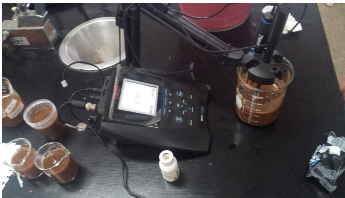
Figura 11. Medición de pH.
