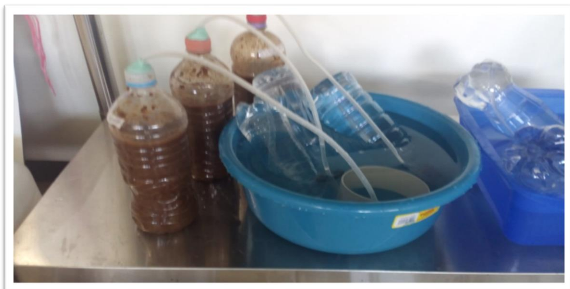
Figura 10. Medición de volumen de gas con el método Parajuli.
