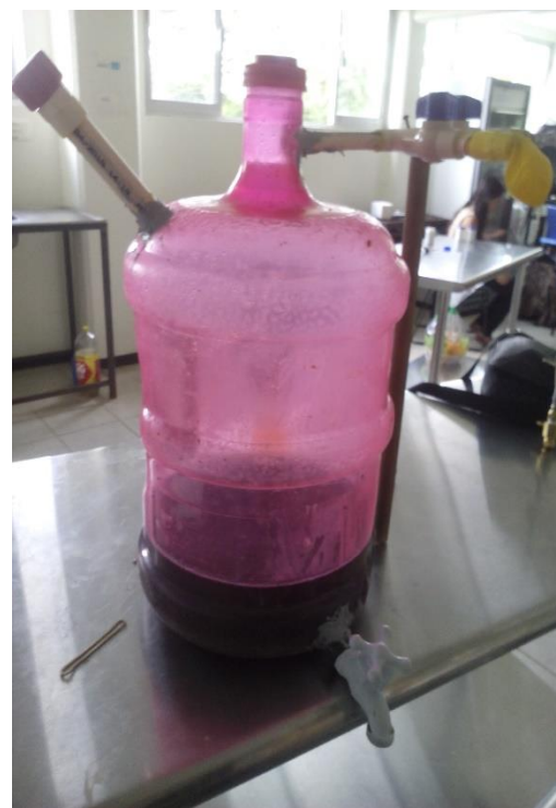
Figura 5. Reactor sin agitación.
