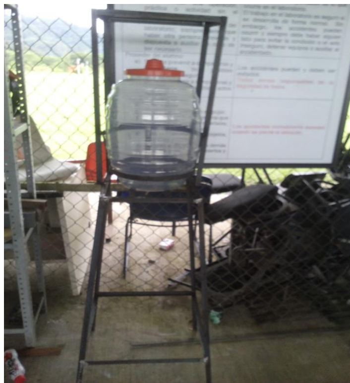
Figura 6. Reactor con agitación.
