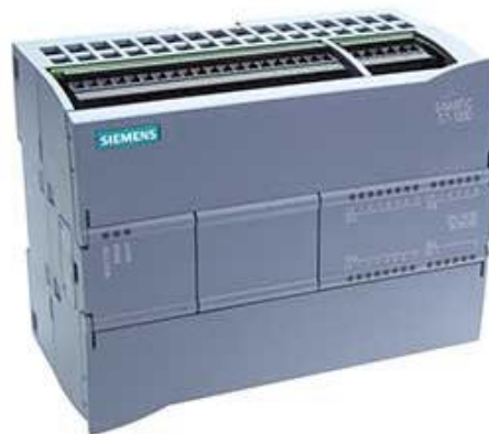
Figura 1.6. Ejemplo de PLC (Tomado de: https://www.automation24.biz/simatic-s7-1200 )
