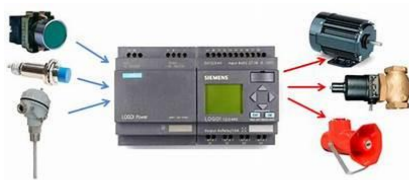
Figura 8 –Esquema de trabajo de un plc (Electromatic)
